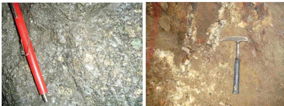
Figura 3.4.- Diseminaciones de calcopirita de los cuerpos mineralizados, y vetas de cuarzo turmalina cortando el intrusivo en el yacimiento de Sarita.
