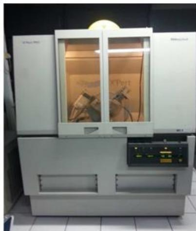
Gambar 3. Alat uji XRD
