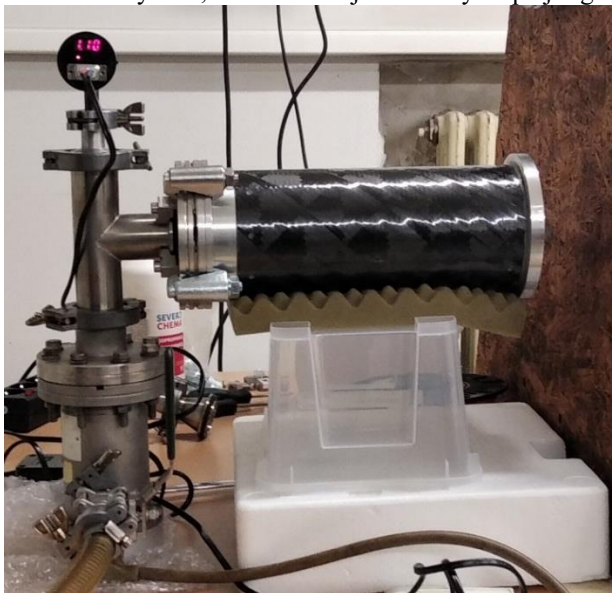
Obr. 3 Měření natékání skrze stěnu vzorku
