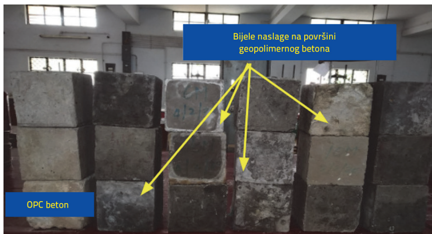
Slika 9. Uzorak nakon uranjanja u natrijev sulfat
