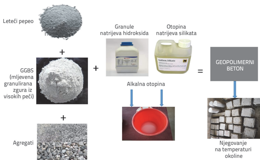
Slika 1. Proizvodnja geopolimernog betona
