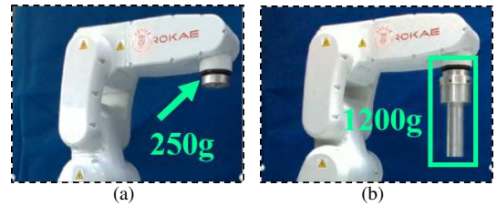
Fig. 4. Payload on end-effector. (a) 0.25 kg. (b) 1.2 kg.
