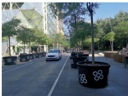
Fig. 7 - Nueva sección de la calle y la vialidad en Barcelona. Reducción a un solo carril de baja velocidad (10km/h) del espacio de circulación del automóvil y ampliación del espacio peatonal y para la movilidad en bicicleta. Foto: Francesc Muñoz
