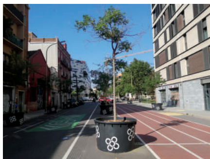
Fig. 7 - Nueva sección de la calle y la vialidad en Barcelona. Reducción a un solo carril de baja velocidad (10km/h) del espacio de circulación del automóvil y ampliación del espacio peatonal y para la movilidad en bicicleta. Foto: Francesc Muñoz
