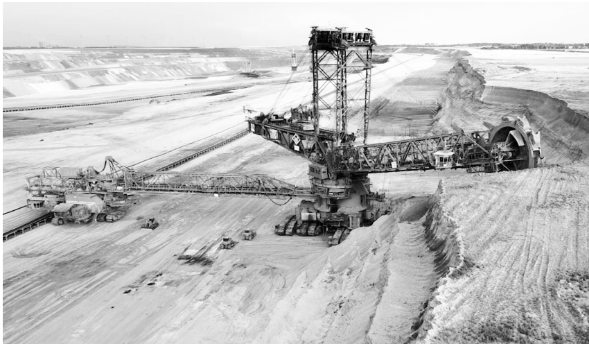
Abbau des Deckgebirges im Braunkohle Tagebau Garzweiler II. Hier befand sich der Ort Borschemich, Foto: Heimatverein der Erkelenzer Lande e. V. / Michael Finken
