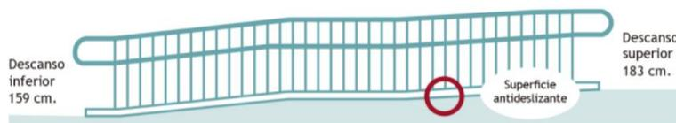
**Fig. 88.** Descansos mínimos en rampas. Fuente: *Manual de uso para la Norma de Reducción de Desastres No. 2 -NRD 2-*
