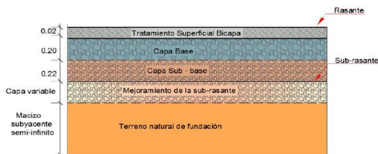
Figura 8. Sección transversal de un pavimento flexible
