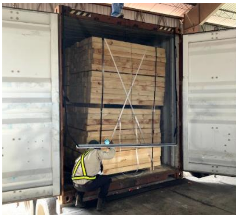
Inspección de madera de pino en la sección de inicio, implementando la malla de contención.
