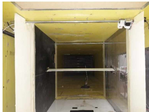
Figura 6 – Modelo de ensayo en túnel de viento
