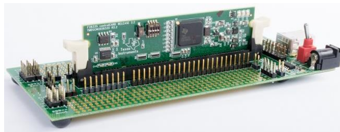
รูปที่ ค-1 บอร์ดไมโครคอนโทรลเลอร์ TMS320F28335 Experimental Kits
