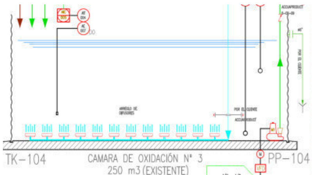
Figura 7: Cámara de Oxidación N°3. Fuente: Elaboración propia.
