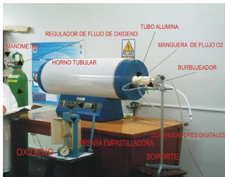
Figura 2.3: Equipo para realizar los tratamientos térmicos.
