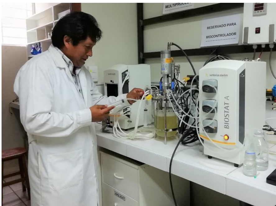
Figura 10. Preparando el Biorreactor Sartorius modelo Biostat A para el tratamiento biológico del efluente de pelambre.
