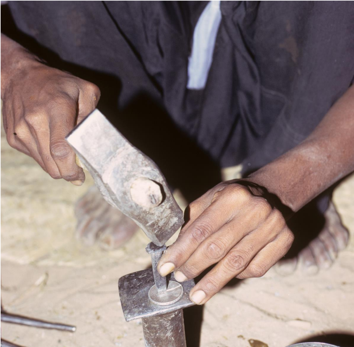
Abb. 34: Nun geht es an das Befüllen des Tiegels mit Silber. Als Gusspeise haben wir Schweizer Silberfrankenstücke zum Wiedereinschmelzen mitgebracht. Diese müssen mit einem Meissel auf dem Amboss zerkleinert werden, damit sie in das Tiegelchen passen.
