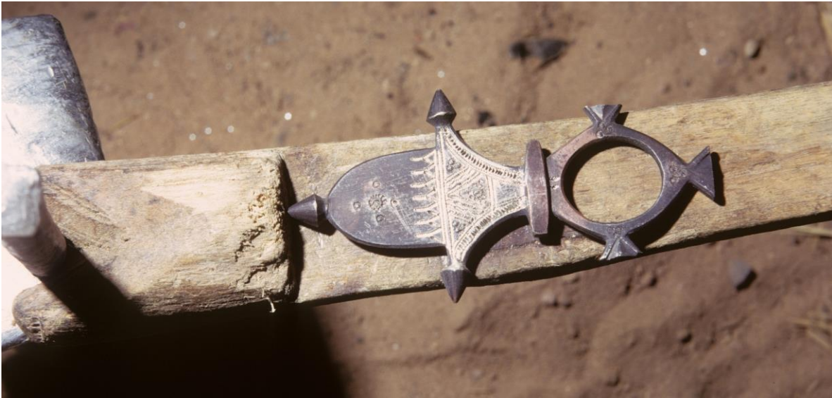
Abb. 56: Dank der im Feuer dunkel gefärbten Oberfläche kann die Arbeit mit dem Tremolierstichel gut beobachtet werden. Als Handhabe dient ein Brettchen mit einem Absatz (links), in dem das Schmuckstück sitzt. Das Brettchen – die Gravierhilfe – findet beim kräftigen Gravieren Halt in einem in den Amboss gesteckten Dorn (ausen links). Am linken Ende des Anhängers sind mit fünf Punzen die «Augen des Chamäleons» (Abb. 16,f) eingeschlagen. Punzen sind Stahlstempel mit verschiedenen Mustern (Abb. 57), die mit dem Hammer in die Metalloberfläche eingeschlagen – «gestempelt» – werden.
