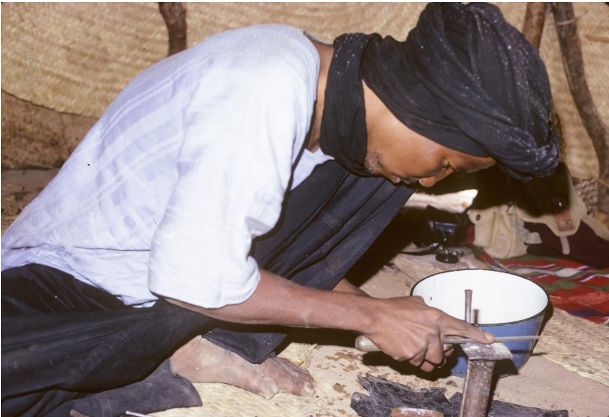
Abb. 52: Mit dem gegossenen Rohling ist die Arbeit an einem Agadez- oder Iférouane-Kreuz erst zur Hälfte fertig! Jetzt muss das Stück noch aufwändig «versäubert» werden, zuerst durch feines Feilen aller Oberflächen (Bild), dann durch Feinschleifen, «Weissieden» und Polieren.
