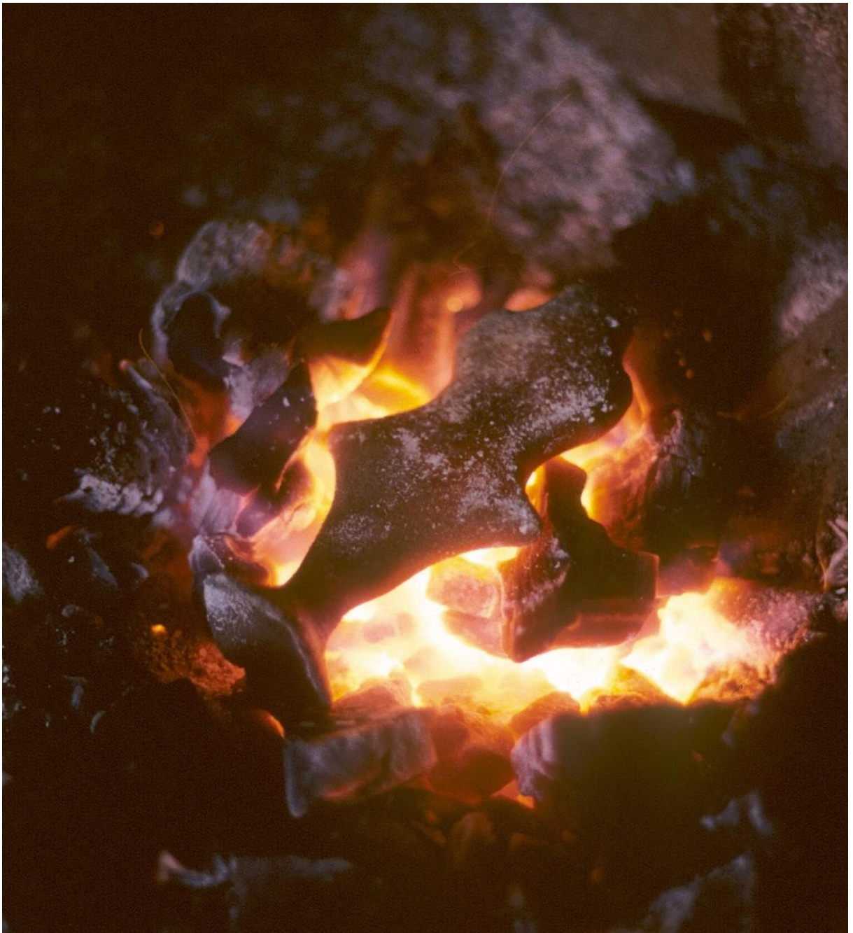
Abb. 40: Die Gussform wird – noch ohne angefügten, gefüllten Tiegel – durchgeglüht.
