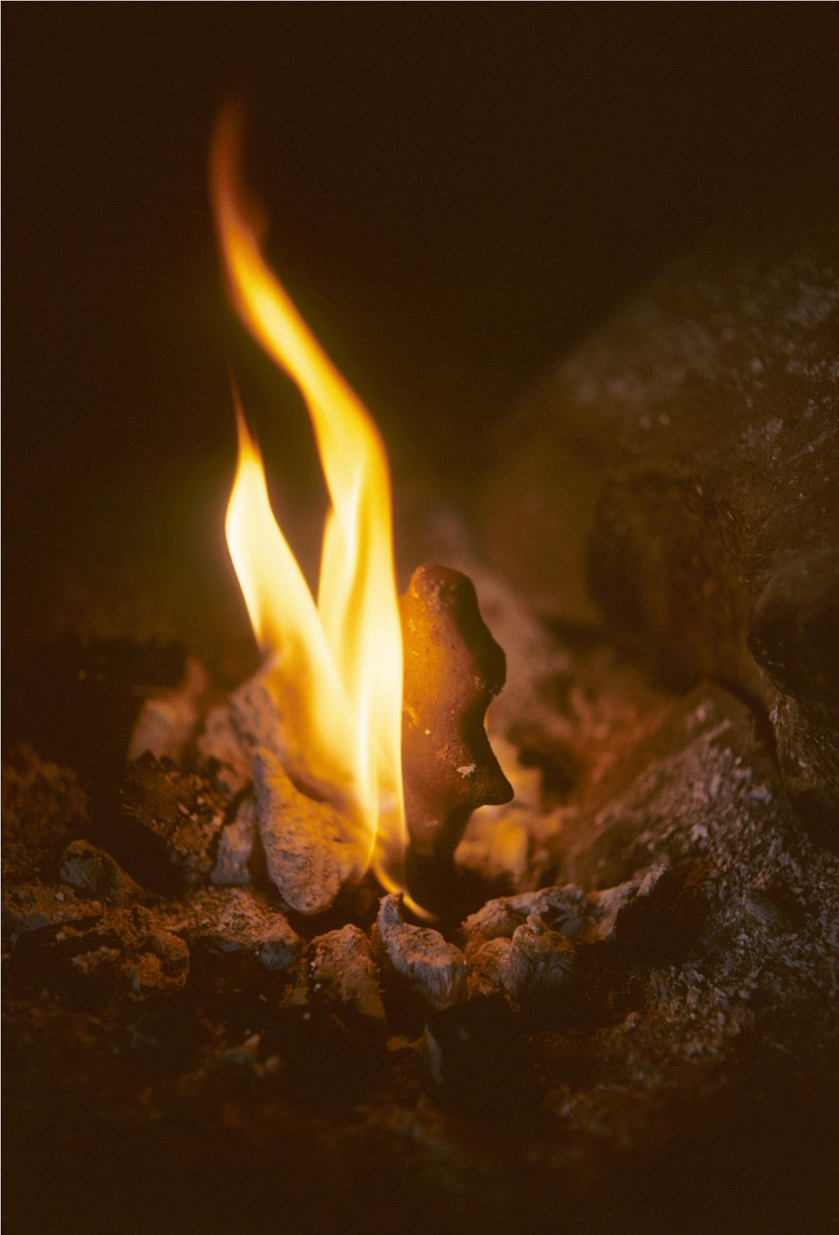
Abb. 43. Nun wird die Gussform «upside-down» im heissen Holzkohlefeuer – wie Keramik – gebrannt. Nur so wird sie den Hitzeschock beim Einfüllen des flüssigen Silbers bei rund 900-1000° C ohne zu bersten überstehen. Der Tiegel steckt unten versteckt in den glühenden Holzkohlen; die oben angefügte Gussform ragt hervor, wird aber ebenfalls tüchtig erhitzt.
