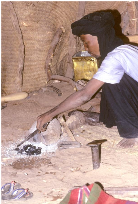
Abb. 29: Inzwischen schürt Hamid erneut das Holzkohlefeuer und bereitet es zum Ausschmelzen des Waxes und anschließend zum Vorbrennen der leeren Gussform vor.
