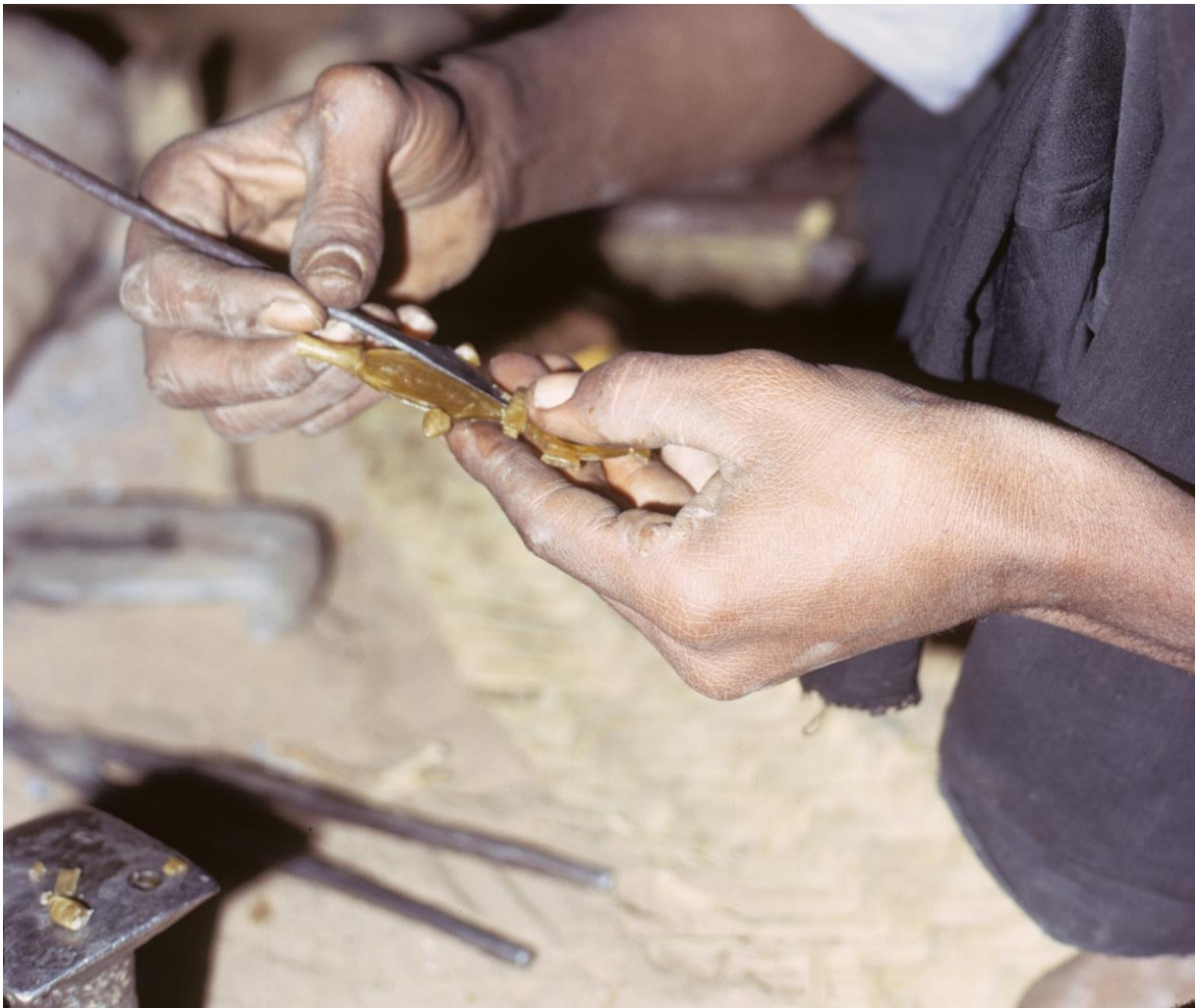
Abb. 24: Desgleichen wir mit einigen Wachströpfchen der Quersteg auf die Platte des Gussmodells «aufgeklebt».
