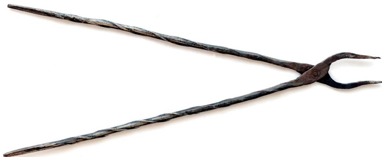
Abb. 31: Kleine Feuerzange zum Feinschmieden von Silberschmuck und zum Halten von glühenden Tiegeln, Gussformen und Holzkohlebrocken. Von Hamid Kumama hergestellt aus dünnem Armierungseisen. Länge: 36 cm.
