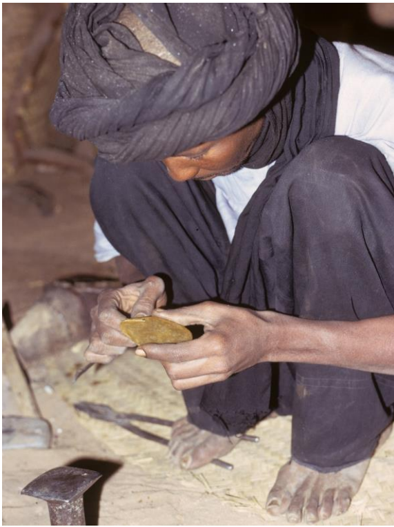
Abb. 21: Agadez, 1973: Der erste Schritt ist die Herstellung des Positiv-Modells eines Iférouane-Kreuzes aus Bienenwachs, das später im «Wachsausschmelzverfahren» mit einer Lehmform umhüllt, dann aus der Form ausgeschmolzen und schlussendlich im Hohlraum in Silber gegossen wird. Die Konturen des geformten Wachsplättchens werden mit einem kleinen, im Feuer erwärmten Metallspatel ausgeschnitten. (Zum Herstellungsprozess allgemein s. auch Furger 2017A, 79 fig. 130)
