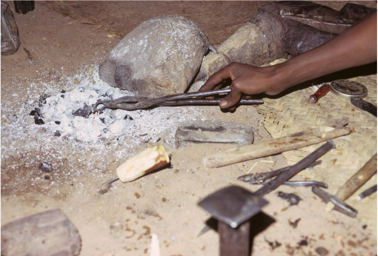
Abb. 50: Der Rohguss wird im Holzkohlefeuer kurz ausgeglüht (dunkelrot), damit sich die Gussstruktur der Silberlegierung homogenisiert. (Zum diesem Rekristallisierungsprozess s. auch Furger 2017B, 29 f. Abb. 3)
