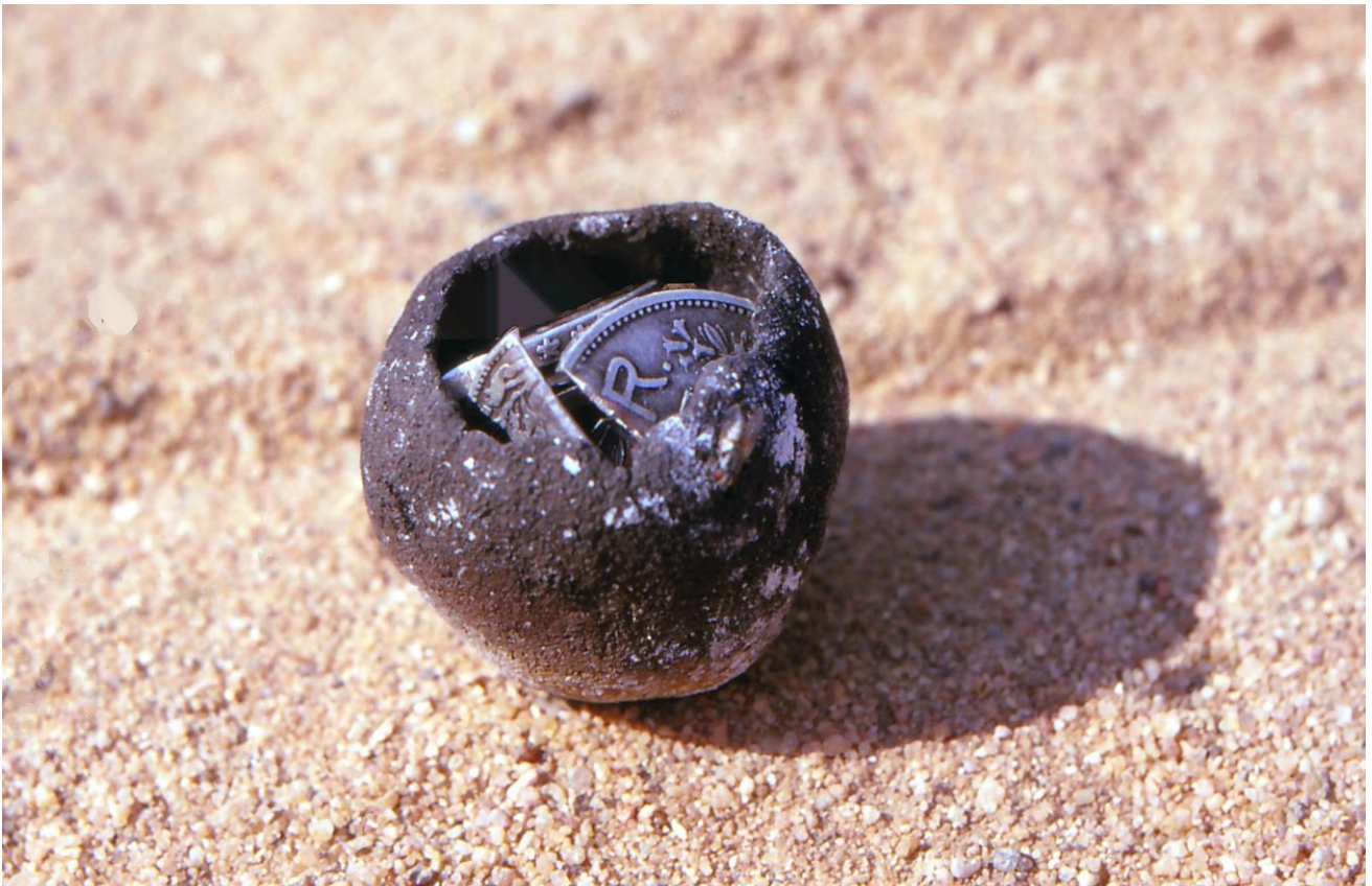
▲ Abb. 38: Der kleine Tiegel ist vorgebrannt und mit zerhackten Silbermünzen bestückt. Als nächstes wird die fertige Gussform mit Lehm auf dem Tiegel aufgekittet.
