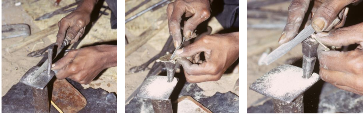
Abb. 54: Das Feilen dauert Stunden. Die Feilspäne sind wertvoll und sollen später wieder eingeschmolzen werden. Daher wird eine schwarze Auffangmatte rings um den im Boden steckenden Amboss gelegt. Die Matte ist aus einem alten Autoschlauch herausgeschnitten; der Amboss ist Teil einer alten Auto-Kardanwelle.
