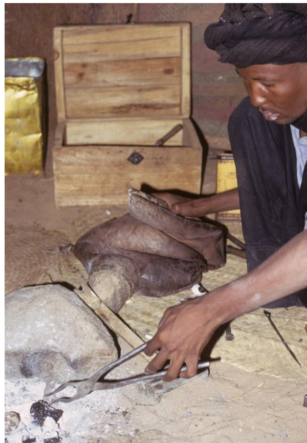
Abb. 30: Die Lehmform wird im Feuer sanft erwärmt und der inzwischen ebenfalls aus Lehm geformte Tiegel (Abb. 38 und 39) getrocknet und im Feuer vorgebrannt.
