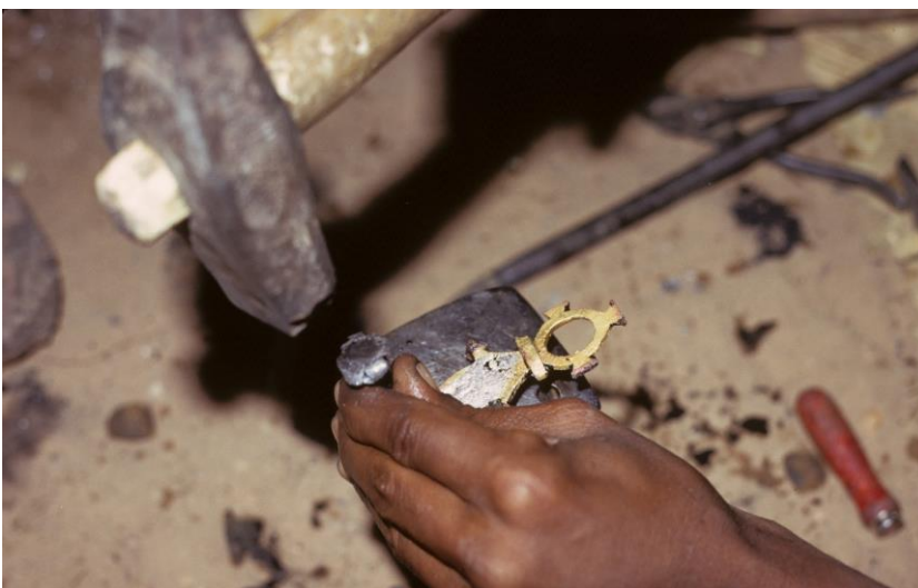
Abb. 49: Das silberne Gussstück ist freigelegt und zeigt die raue, gelbliche «Guss­haut». Diese muss jetzt noch gefeilt und poliert werden. Zuerst wird der Einguss­trichter (Gusszapfen; Abb. 25 und 28) mit dem Meissel abgetrennt (Bild).
