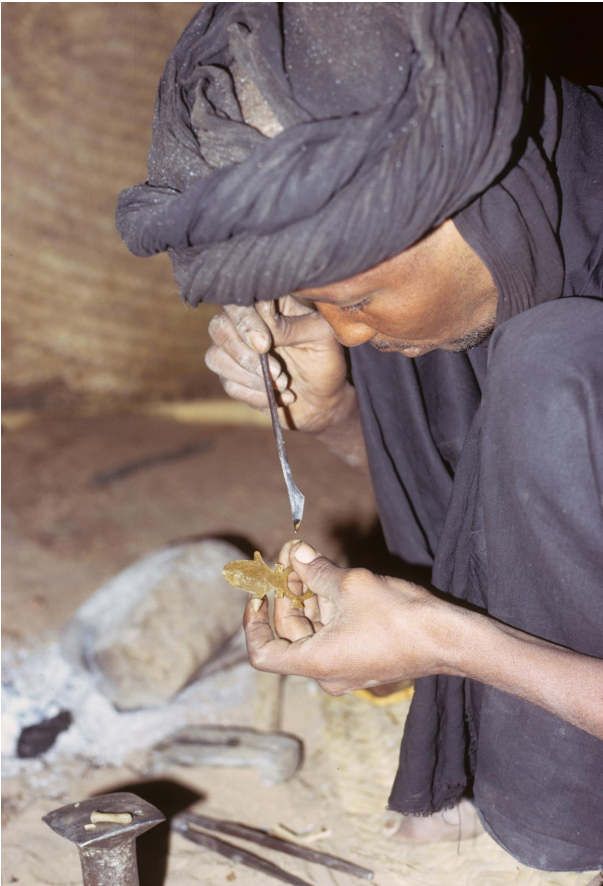
Abb. 23: Hamid Kumama träufelt etwas flüssiges Bienenwachs auf den kleinen, separat geformten Wachskegel, um ihn anschliessend an der «Schulter» des künftigen Silberschmucks zu befestigen (vgl. Abb. 16,c,d).
