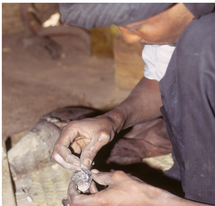
Abb. 37: Die Silberstückchen werden in den trockenen und vorgebrannten Tiegel gefüllt. Anschliessend wird die Gussform mit dem Tiegel mithilfe von etwas nassem Lehm zu einem Ganzen zusammengefügt: der Tiegel mit dem Silber unten, die hohle Gussform oben (siehe Abb. 41).
