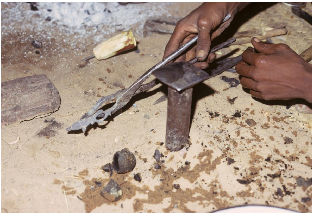
Abb. 51: Damit das glühende Stück homogen rekristallisieren kann, wird es nicht im Wasser abgeschreckt, sondern in den Sand des Werkstattbodens gesteckt und dort langsam erkalten gelassen. Am Boden davor liegen der Tiegel und die Bruchstücke der Gussform.
