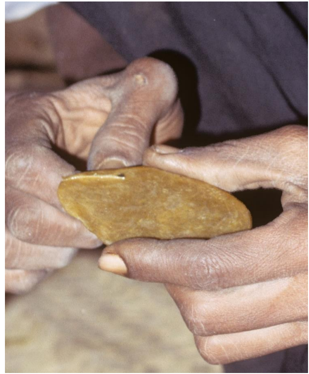
Abb. 21: Agadez, 1973: Der erste Schritt ist die Herstellung des Positiv-Modells eines Iférouane-Kreuzes aus Bienenwachs, das später im «Wachsausschmelzverfahren» mit einer Lehmform umhüllt, dann aus der Form ausgeschmolzen und schlussendlich im Hohlraum in Silber gegossen wird. Die Konturen des geformten Wachsplättchens werden mit einem kleinen, im Feuer erwärmten Metallspatel ausgeschnitten. (Zum Herstellungsprozess allgemein s. auch Furger 2017A, 79 fig. 130)
