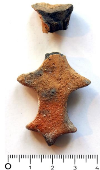
Abb. 48: Eine andere «Cire-perdu»-Gussform nach dem primären Brennen des Lehms. Sie ist gebrannt, aber innen leer. Weil sie beim Brennen (Abb. 40) zerbrochen ist, konnte sie nicht mehr zum Giessen verwendet werden – die ganze Arbeit am Wachsmo­dell und Formenbau war vergeblich! Natürliche Grösse.
