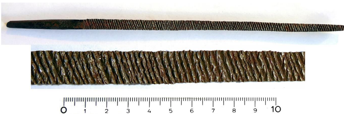
Abb. 53: Alte Feile aus dem Werkzeugfundus von Hamid Kumama (1973). Das handgefertigte kleine Werkzeug ist aus einem Stahlstäbchen mit Parallelhieb und stellenweise mit Kreuzhieb hergestellt und anschliessend gehärtet worden (s. auch Furger 2020, 18 Abb. 8). Es war damals bereits nicht mehr in Gebrauch. Die Schmiede zogen anstelle solcher selbst mit «Handhieb» gefertigten Feilen die viel härteren Industrieprodukte aus Frankreich vor. Massstab 1:1 (Länge: 16 cm, Detail 3× vergrössert).
