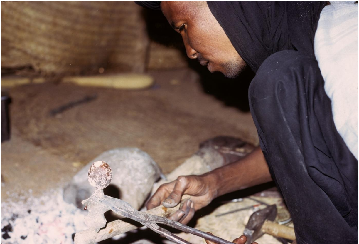
Abb. 44: Der erste Höhepunkt bei der traditionellen Herstellung eines Touareg-Kreuzes im Wachsauerschmelzverfahren: Die Gussform mit unten angesetztem Tiegel wird dann aus dem Feuer genommen, wenn das Silber unten im Tiegel flüssig geworden ist. Der erfahrene Giesser erkennt den richtigen Moment an der Farbe des Feuers und der glühenden Gussform. Er nimmt das Objekt mit der Zange sorgfältig aus dem Feuer, erkennt am leichten Schwappen, dass das Metall wirklich flüssig ist, und dreht das Objekt schnell mit der Zange um 180 Grad. Der Tiegelinhalt – das flüssige Silber – ist beim Drehen aus dem Tiegel in die jetzt unten liegende Gussform geflossen (Bild)! Das geschlossene Gussform-Tiegel-System verhindert den Zutritt von Sauerstoff und allfälligen Verschmutzungen und schafft eine reduzierende Atmosphäre im Innern – die Gefahr von Oxidation und Fehlgüssen wird dadurch markant vermindert. Diese geschlossene Giesstechnik ist in vielen Ländern Afrikas bei Silber- und Bronzegießern, aber auch in Asien, verbreitet.
