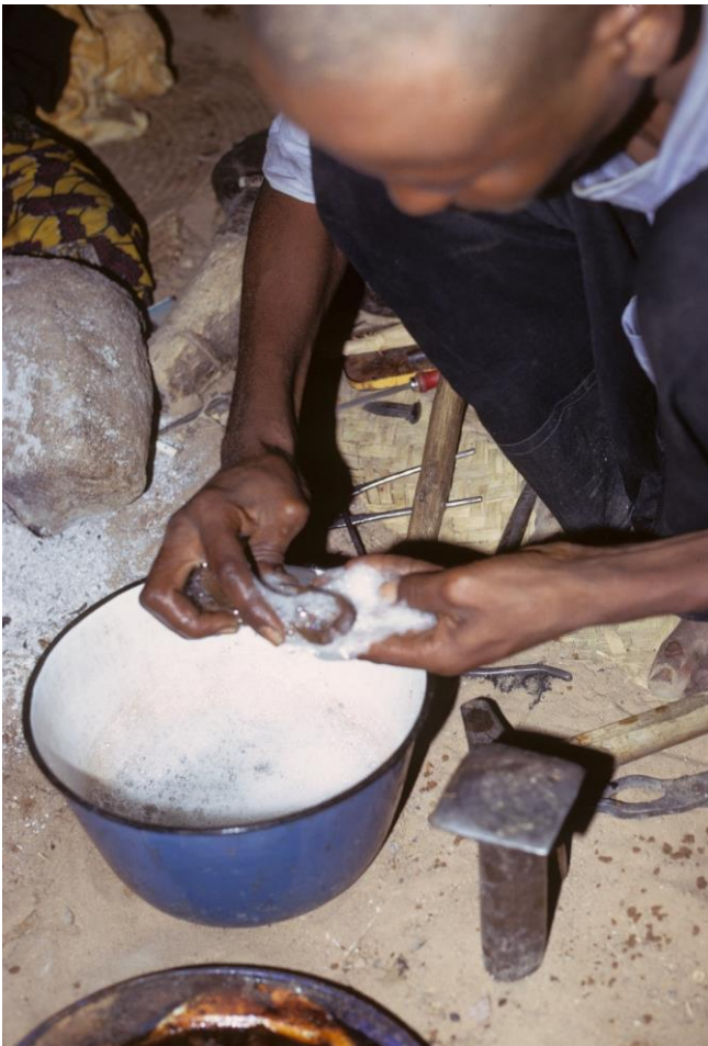
Abb. 60: Nach dem Weissieden wird das Silberobjekt in einer Seifenlauge mit einer Bürste «gekratzt» und auf Hochglanz gebracht. Hamid: «L'Omo [Waschmittel] de Nigéria polit mieux que l'Omo du Niger».
