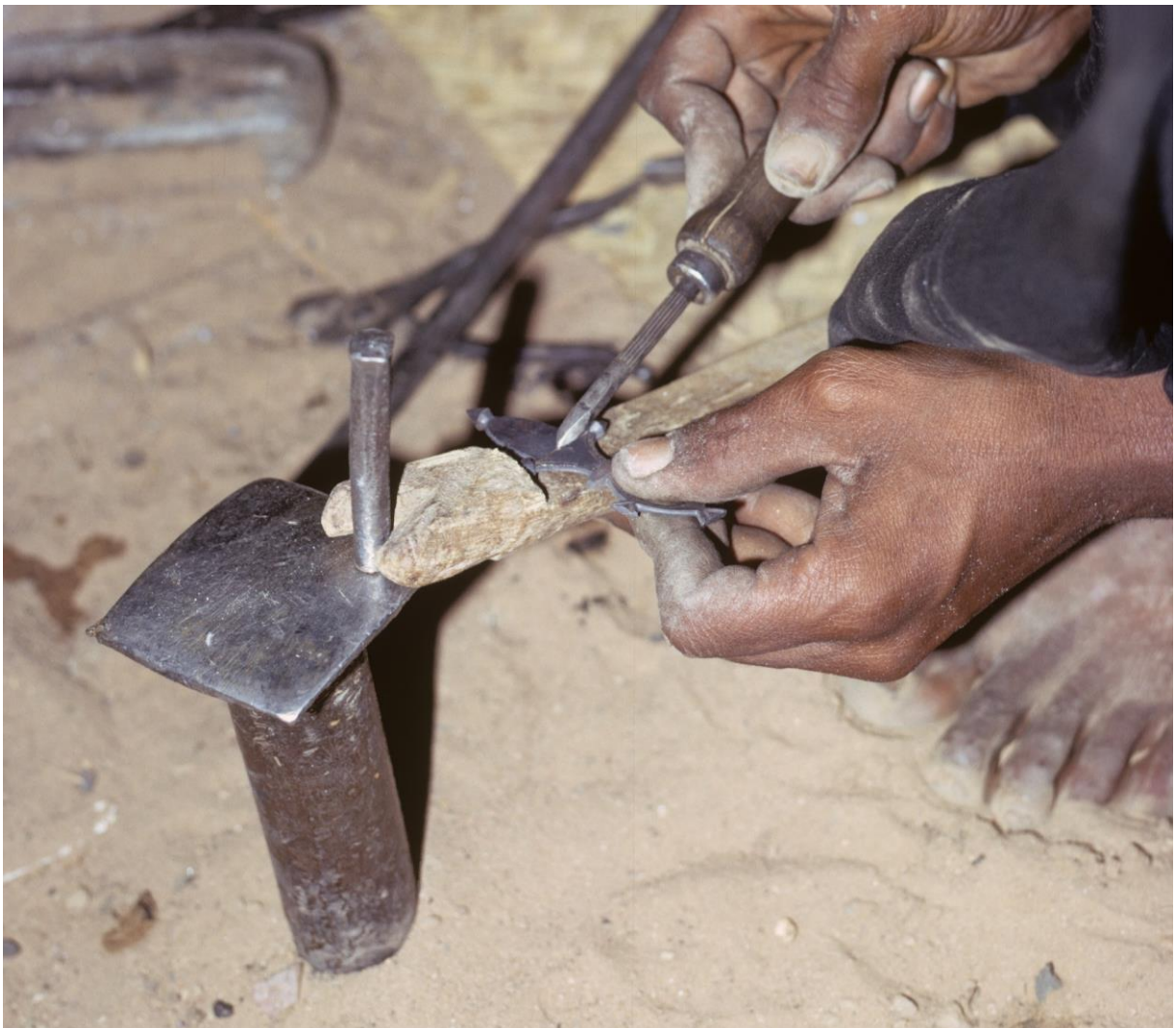
Abb. 55: Nach dem Feilen wird das Schmuckstück im Feuer etwas gegläht, um die Silber-Oberfläche dunkel zu färben. So kann die nun folgende Ziselierarbeit mit dem Stichel besser beobachtet werden (vgl. Abb. 19). Der Stichel hat ein scharfes, lanzettförmiges Ende, mit dem ganz feine Zickzack-Linien in das Silber graviert werden können (Abb. 20). Der Stichel muss hierfür mit dosierter Kraft wippend hin und her gestossen werden: Ein «Tremolierstich» entsteht.
