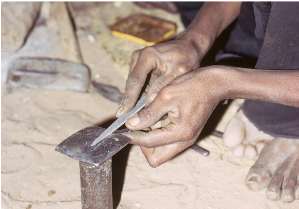
Abb. 22: Der Wachsspatel wird zwischendurch mit der Feile geschärft.
