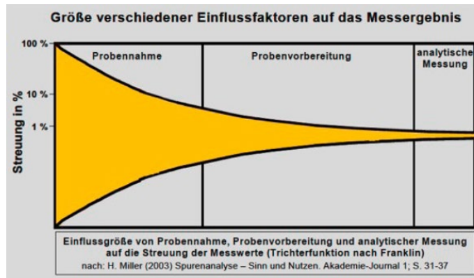
Abbildung 1: Einfluss der Probenahme, Probenvorbereitung und analytischer Messung auf die Streuung der Analyseergebnisse. (Quelle: Rombach et al., 2020)
