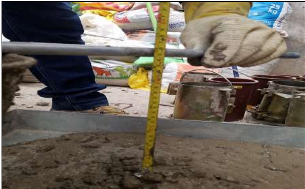
Figura 28: Asentamiento y/o Slump de la mezcla de concreto (con aditivo al máximo) Fuente: Elaboración propia
