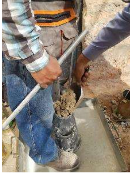
FIGURA 21 Ensayo de asentamiento
