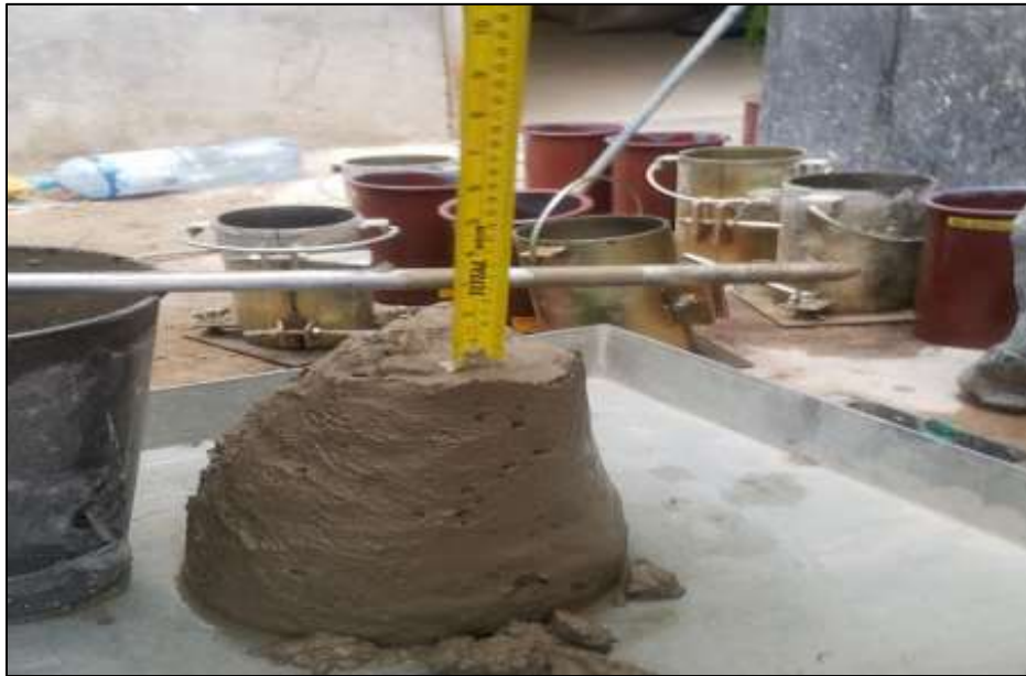
Figura 13: Asentamiento y/o Slump de la mezcla de concreto (sin aditivo) Fuente: Elaboración propia
