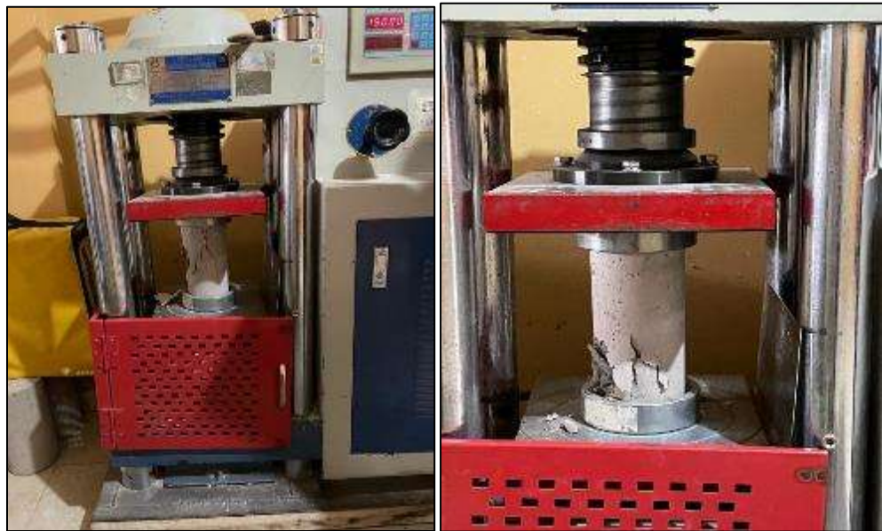
Figura 30: Ensayo a la compresión de las probetas Fuente: Elaboración propia
