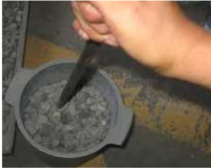
Figura 9 Cálculo del peso unitario compactado.
