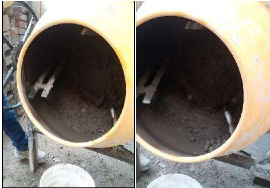
Figura 17: Proceso de mezcla de los agregados (con aditivo al mínimo) Fuente: Elaboración propia
