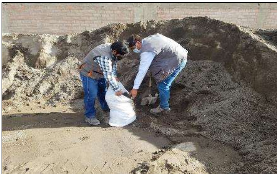
Figura 02: Recolección de agregados (Canteras 48) Fuente: Elaboración propia
