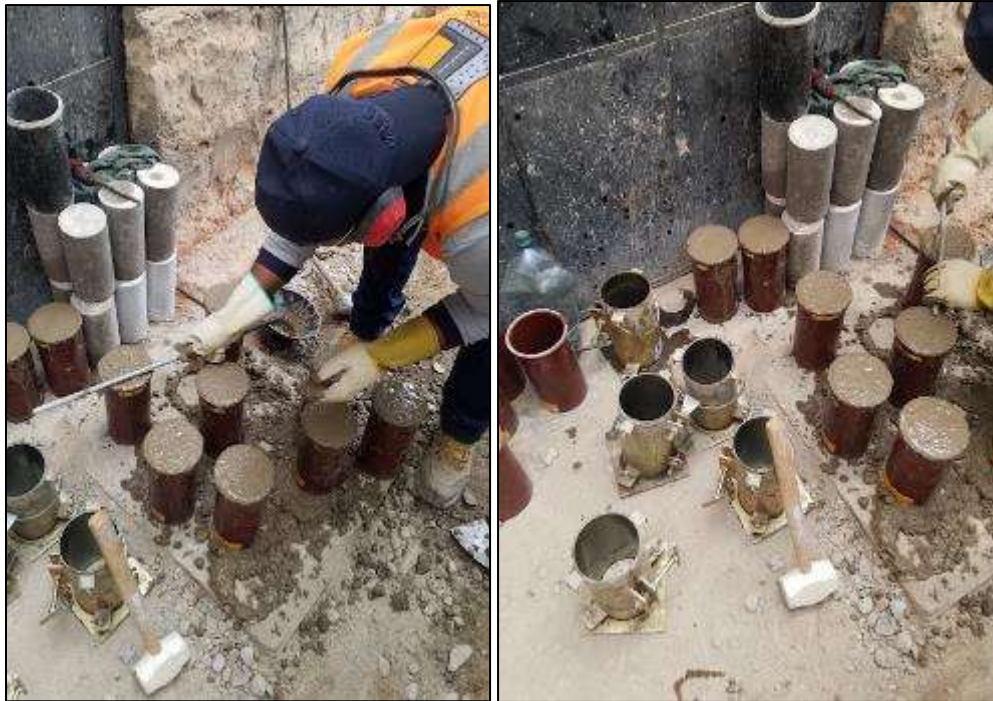
Figura 29: Desmoldado de testigos de concreto Fuente: Elaboración propia
