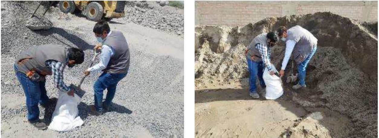
FIGURA 16 Extracción de agregados de canteras
