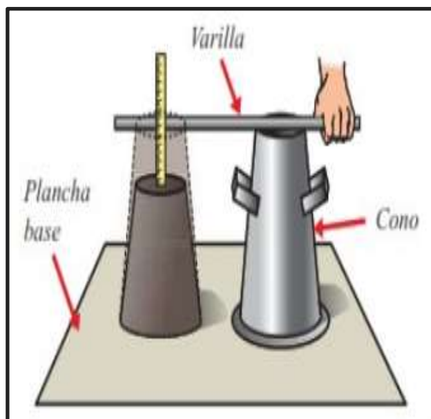
Figura 11 Prueba del Slump.
