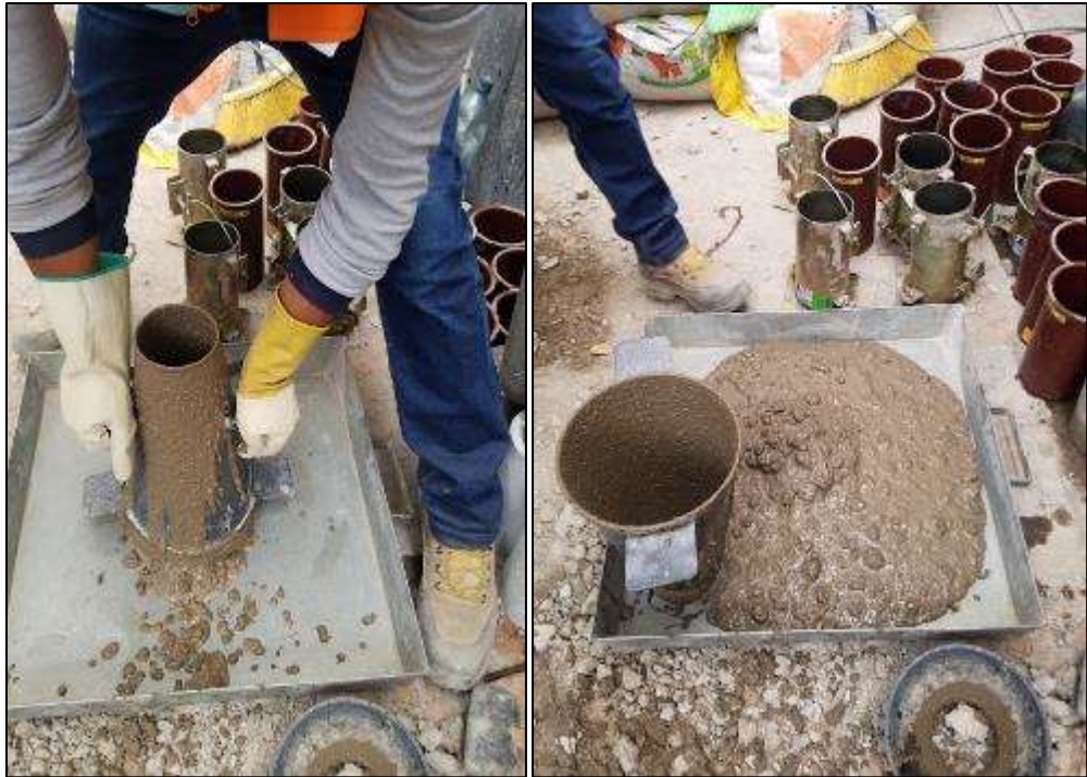
Figura 27: Ensayo de cono de Abrams retiro del cono de Abrams (con aditivo al máximo) Fuente: Elaboración propia
