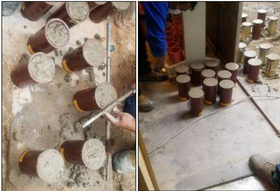
Figura 16: Testigos de concreto según diseño de mezcla (sin aditivo) Fuente: Elaboración propia
