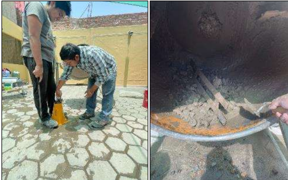
Figura 31: Preparación de la mezcla de concreto en estado fresco Fuente: Elaboración propia
