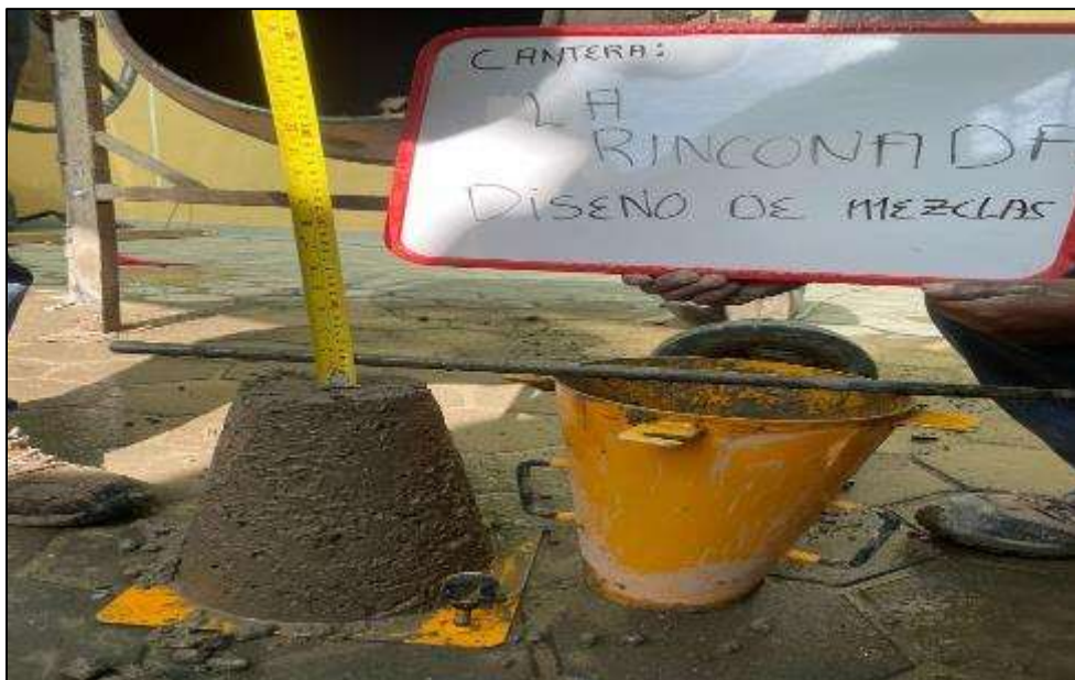
Figura 38: Asentamiento y/o slump (Cantera la Rinconada) Fuente: Elaboración propia
