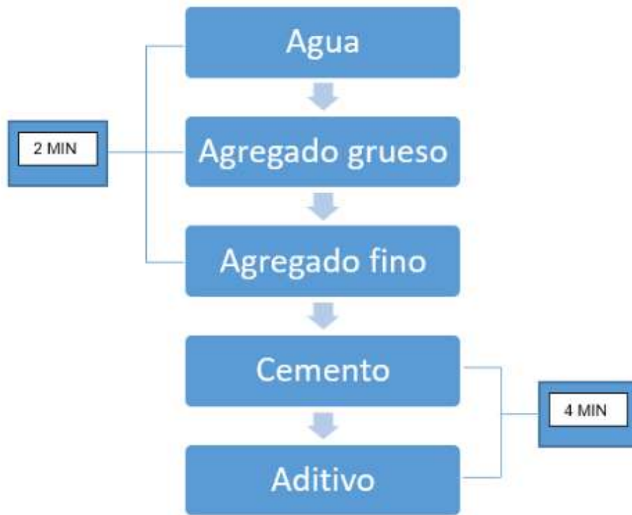
FIGURA 19 Proceso convencional de mezclado en laboratorio
