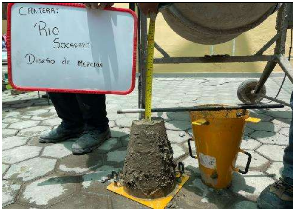
Figura 32: Asentamiento y/o slump (Cantera Río Socabaya) Fuente: Elaboración propia
