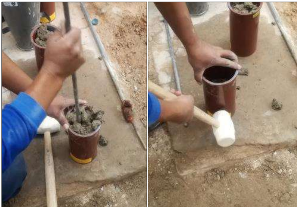
Figura 24: Varillados y golpes según normas de diseño (con aditivo al mínimo) Fuente: Elaboración propia
