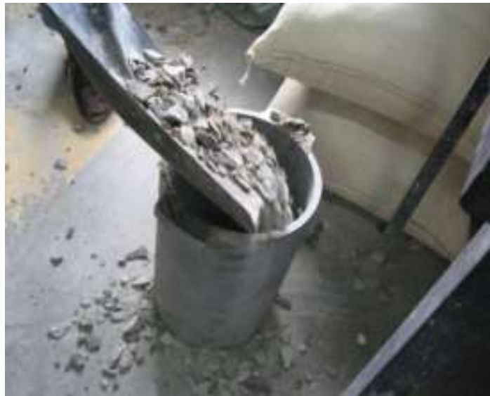
Figura 8 Cálculo del peso unitario suelto.
