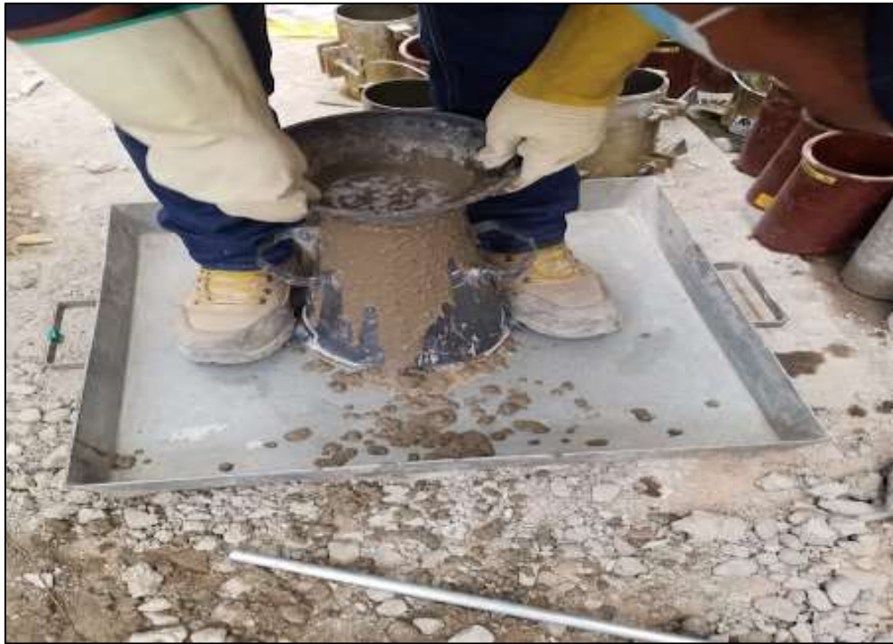
Figura 25: Ensayo de cono de Abrams de los agregados (con aditivo al máximo) Fuente: Elaboración propia
