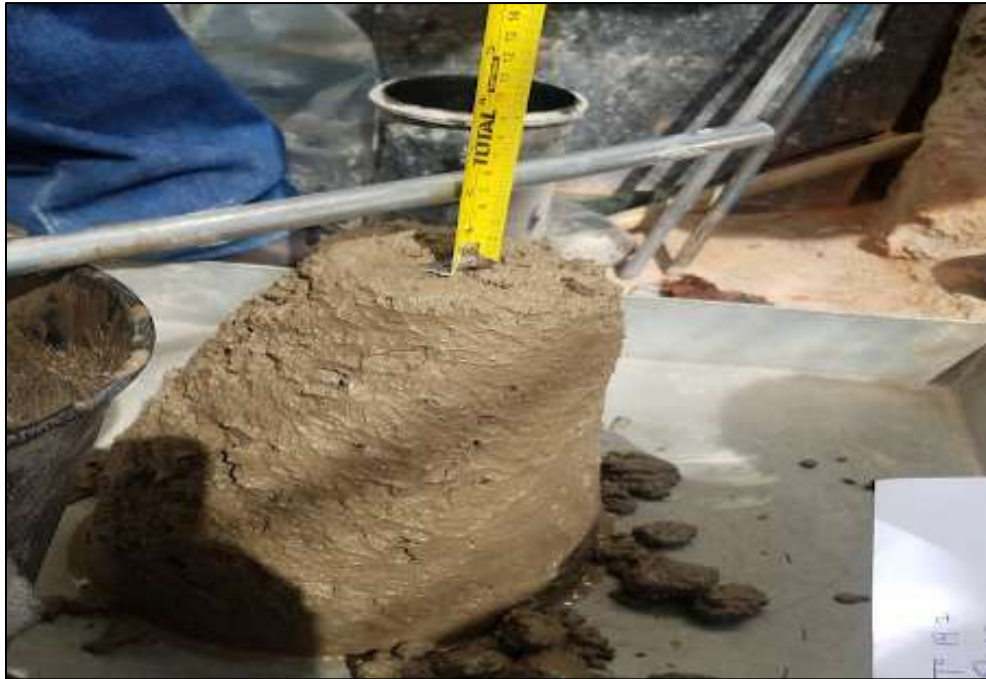
Figura 23: Asentamiento y/o Slump de la mezcla de concreto (con aditivo al mínimo) Fuente: Elaboración propia
