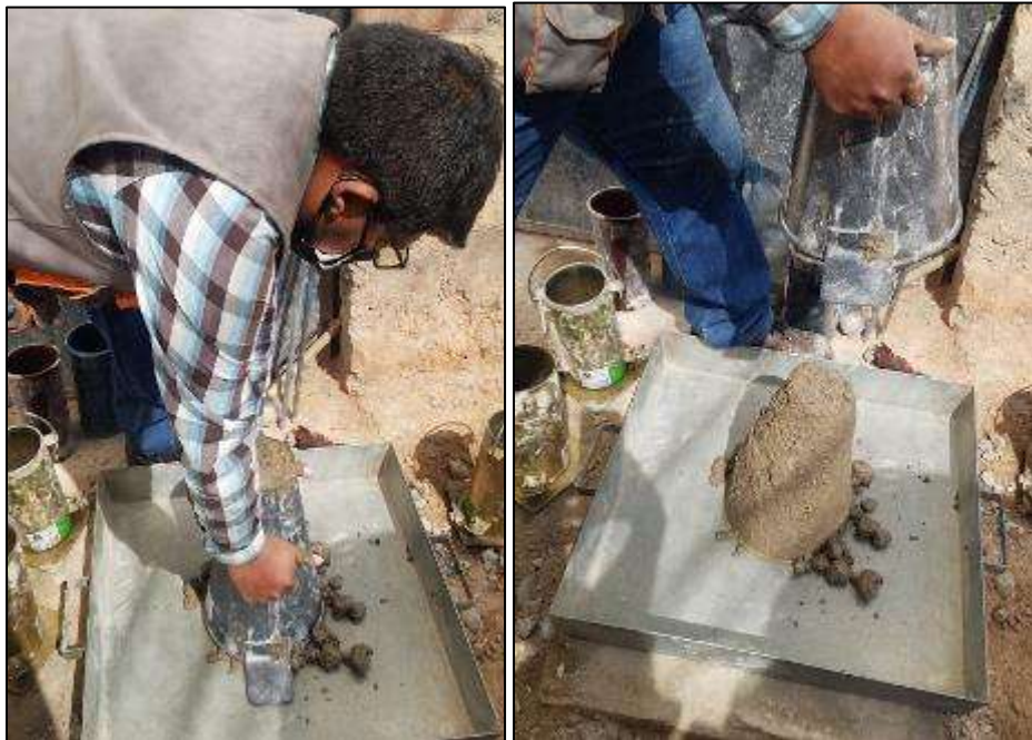
Figura 22: Ensayo de cono de Abrams retiro del cono de Abrams (con aditivo al mínimo) Fuente: Elaboración propia
