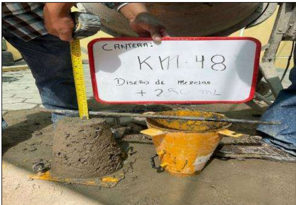
Figura 36: Asentamiento y/o slump con aditivo al mínimo (Cantera Km 48) Fuente: Elaboración propia
