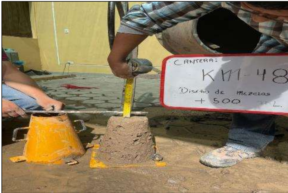
Figura 37: Asentamiento y/o slump con aditivo al máximo (Cantera Km 48) Fuente: Elaboración propia
