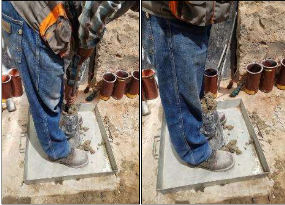
Figura 21: Ensayo de cono de Abrams varillado final (con aditivo al mínimo) Fuente: Elaboración propia
