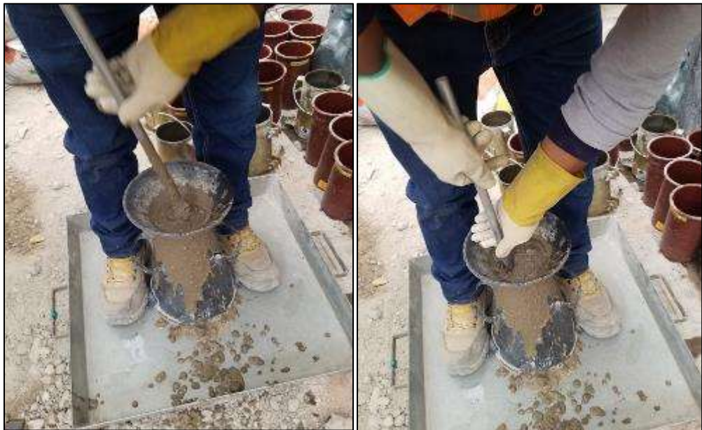
Figura 26: Ensayo de cono de Abrams varillado por capas (con aditivo al máximo) Fuente: Elaboración propia
