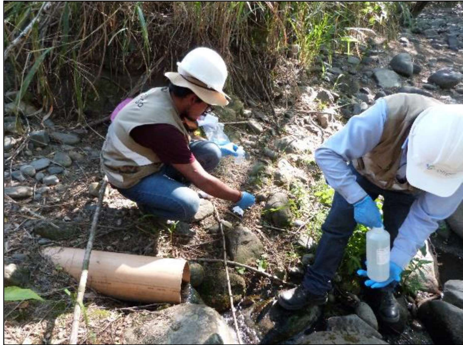
Figura 12. Toma de muestra del efluente de la PTAR Pampa Concepción
