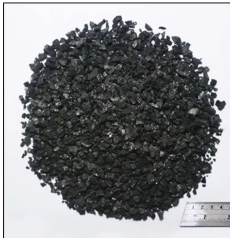
Figura 9. Carbón Activado Granular ( \varnothing 3mm.) de Bambú
