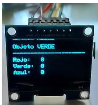
Figura 38. Se muestra por pantalla el color identificado mediante la función "identificarColor ()" ( imagen propia )
