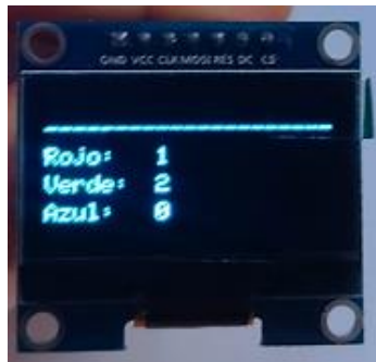
Figura 34. Texto mostrado por la pantalla tras ejecutarse el bucle de las funciones nombradas ( imagen propia )
