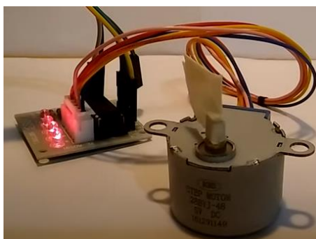
Figura 53. Ejemplo de LEDs encendidos del driver del motor indicando la energización de las bobinas (Bitwiser, Paso a Paso (unipolar) 28BYJ-48 con Driver ULN2003, 2017)
