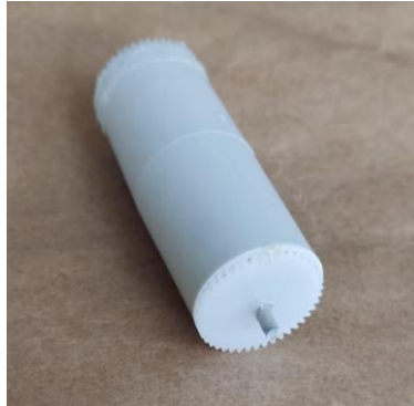
Figura 49. Cilindros conductores del movimiento de la cinta transportadora
