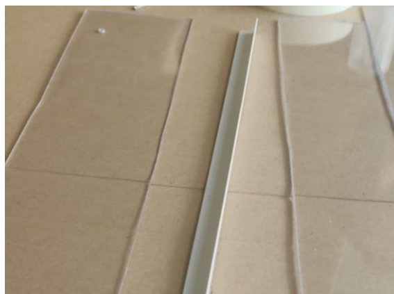
Figura 45. Perfil en "L" de PVC empleado para unir las diferentes piezas de polivinilo
