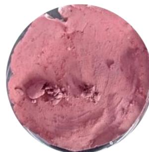
**Gambar 2.** Komposit kitosan-Fe<sub>2</sub>O<sub>3</sub>
