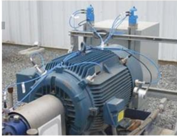
Рис. 1.4 Система контролю двигуна на основі накопичення енергії вібрації [6]
