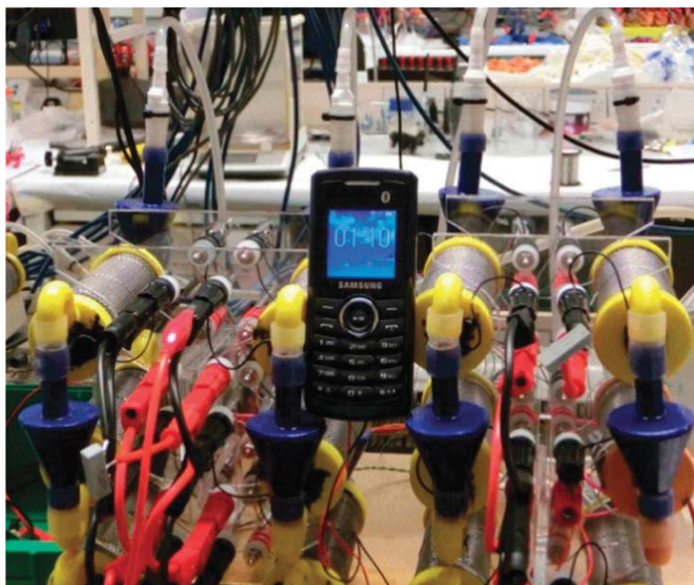
Рис.1.7.12 Перша MFC система зарядження мобільного телефону мікробною біоелектрикою була громіздкою та складалася з двох блоків паралельно з'єднаних 12-послідовно з'єднаних керамічних MFC (Ieropoulos et al., 2013)
