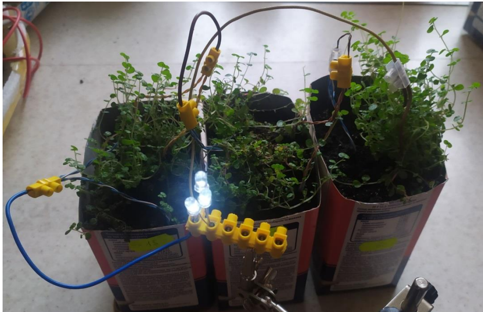
Рис. 3.5.15 Компактна біосистема з H. soleirolii , сконструйована шляхом послідовного з'єднання трьох модулів, служить автономним та сталим джерелом живлення для трьох світлодіодів, забезпечуючи підсвітку протягом декількох місяців експерименту
