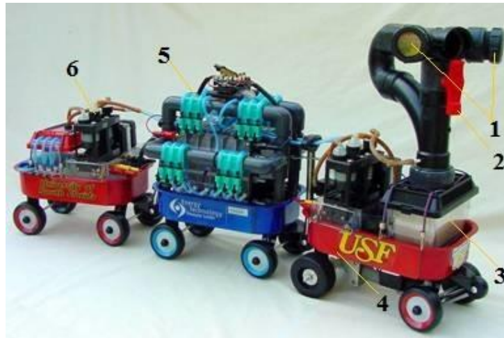
Рис.1.7.9 Гастроробот, розроблений Вілкінсон (Wilkinson, 2000), джерелом енергії для функціонування якого є біоелектрика E. coli : 1 – ультразвукові «очі», 2 – «рот», куди подається поживний розчин з глюкозою для розвитку бактерій, 3 – MFC-реактор, де розвиваються E. coli , 4 – двигун гастроробота, 5 – запас батарейок, 6 – помпа для редокс розчину
