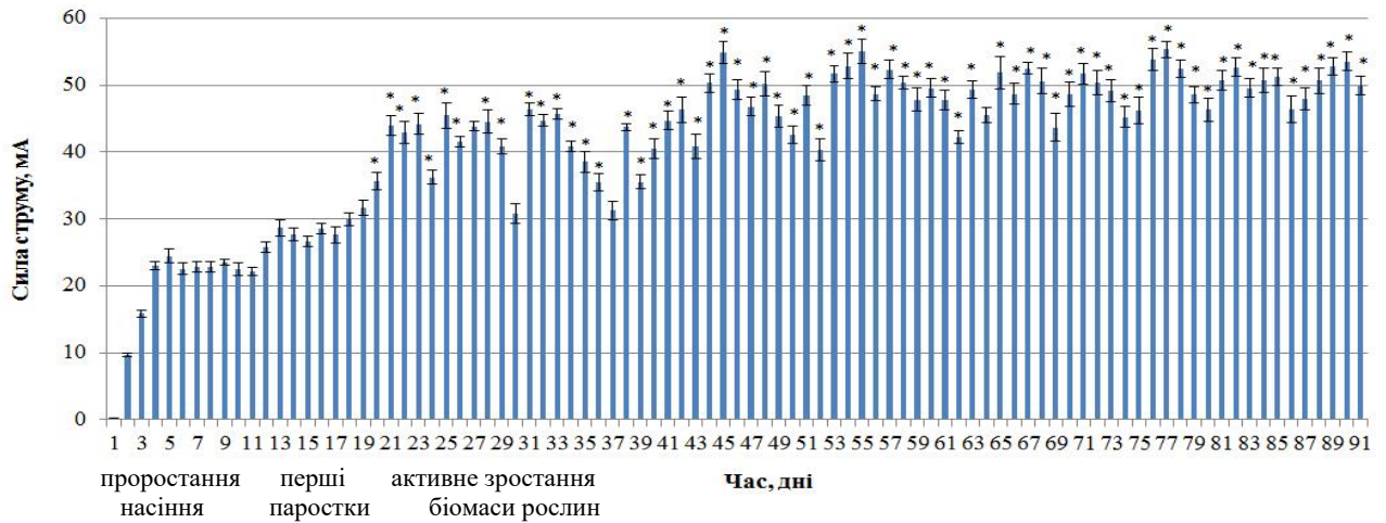
Рис. 6.1.1 Генерація сили струму біотехнологічною системою із F. arundinacea протягом перших 3 місяців після її інсталяції ( \bar{x} \pm SE, n=20 ).
