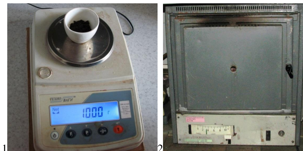
Рис. 2.6.1 Зважування зразків (1) перед поміщенням у муфельну піч для висушування при 460°C (2)
