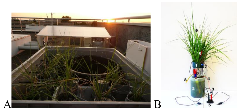
Рис. 1.5.1 Перші розробки рослинно-мікробних біосистем генерації біоелектрики проводилися з рослиною Spartina anglica на зелених дахах (А) та в лабораторних умовах (В) (Helder et al., 2012): 1 – анодний компартмент, 2 – катодний компартмент, 3 – дроти від аноду, 4 – дроти від катоду, 5 – зовнішній резистор, 6 – референсний електрод, 7 – точка подавання води та ростового середовища для рослин, вихід з анодного компартменту, 9 – рослина S. Anglica
