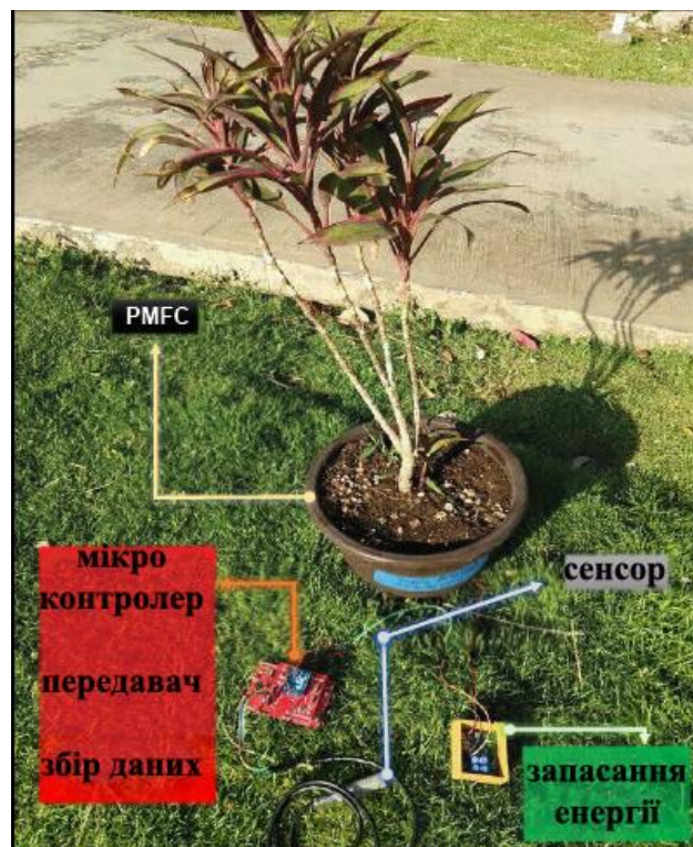
Рис. 1.7.5 Загальний план будови C. fruticosa -PMFC для енергоживлення сенсорної системи IoT-WSN (de la Rosa et al., 2019)
