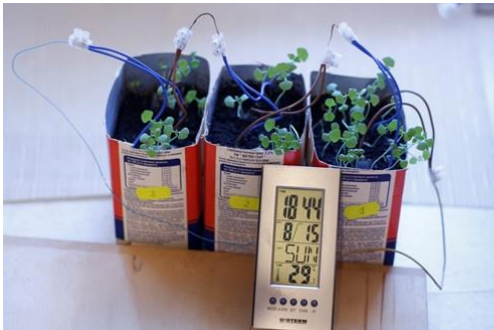
Рис. 3.5.17 Компактна біосистема з базиліком кімнатним, сконструйована шляхом послідовного з'єднання трьох біомодулів, служить автономним та сталим джерелом живлення протягом декількох місяців експерименту для цифрової метеостанції, що включає годинник-календар-термометр-таймер
