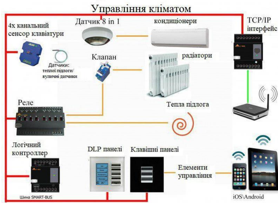
Рис. 2.2 Типова реалізація системи управління мікрокліматом
