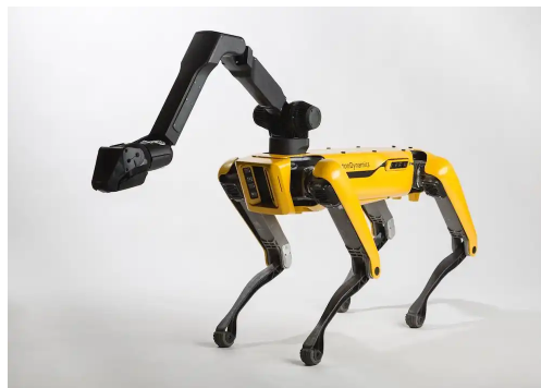
Figura 4.2. Personalización de Spoc con un brazo robot
