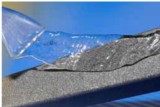
Fig. 1 - Rivestimento DAC ® applicato su uno stelo protesico femorale con superficie in titanio sabbiato (Recta, AdlerOrtho Srl)
