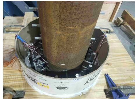
(d) Sonotube for encasement
