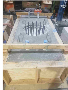
(d) Removal of styrofoam
