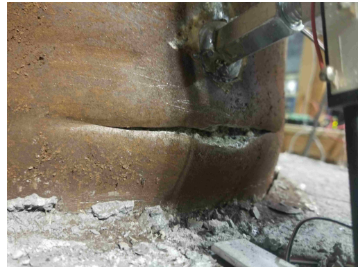
(d) Tearing of tube at 7\Delta y
