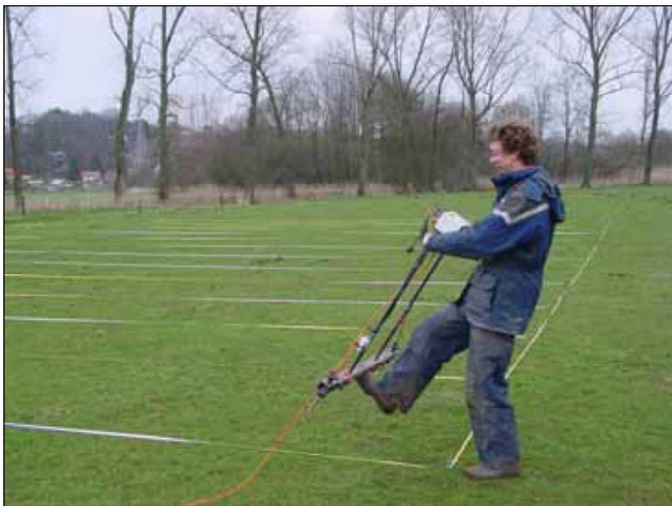
Figuur 16. Impressie van het geofysisch weerstandsonderzoek in het onderzoeksgebied.
