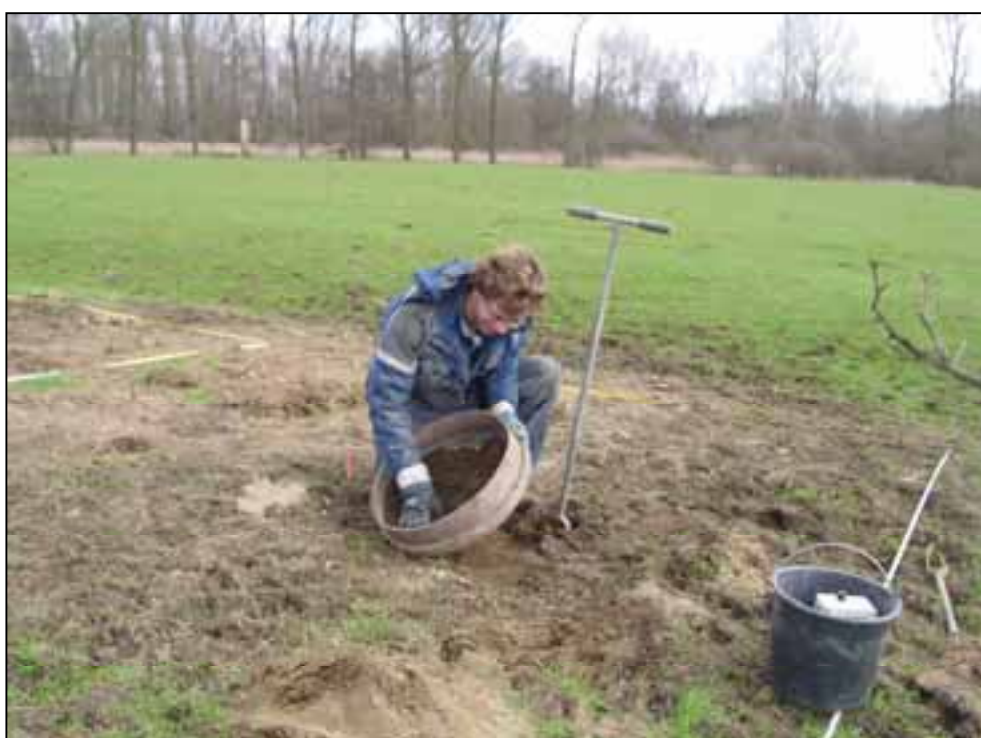
Figuur 13. Het zeven van het opgeboorde sediment.
