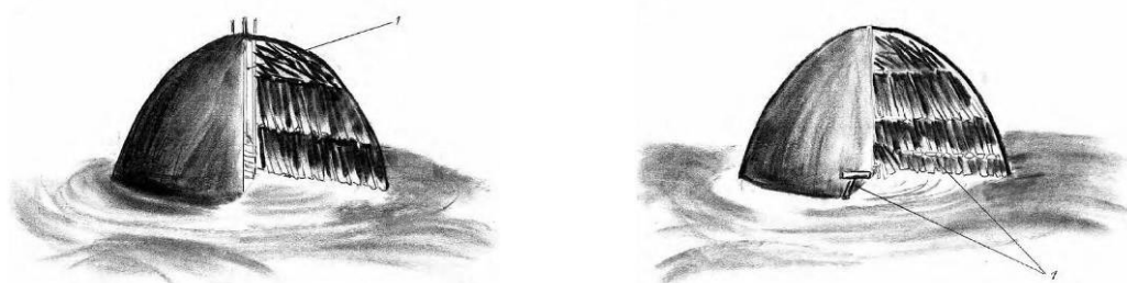
Fig. 3.1 Platzmeiler die aangestoken kan worden langs boven (links), waarbij 4 palen die boven aan de meiler uitsteken het onstekingskanaal markeren waarlangs de meiler met gloeiende houtskool in brand wordt gezet, of langs onder (rechts), waarbij de meiler door een onstekingskanaal (1) onderaan met behulp van een staaf in brand wordt gezet.
