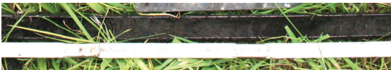
Figuur 32 Afwisseling van humeus zand en veen in boring 13 (raai 2)
