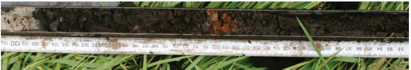
Figuur 27 detailopname van het veen in boring 9 (raai 1)
