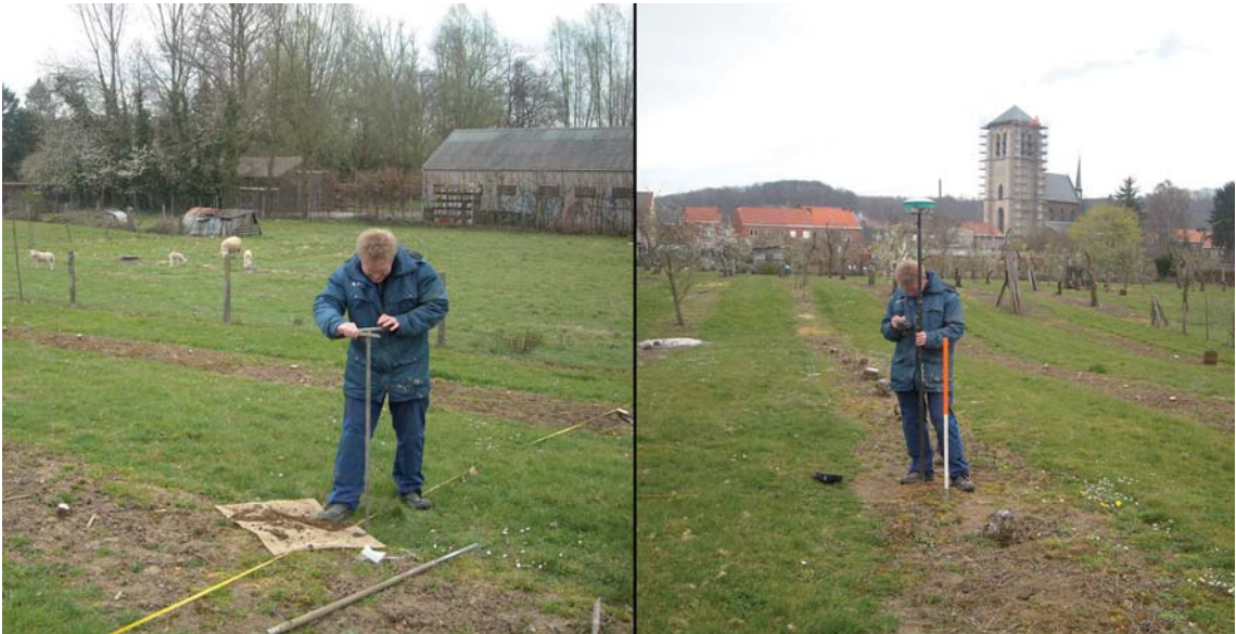
Figuur 44. Impressie van het booronderzoek met een Edelmanboor en het inmeten door middel van een GPS.
