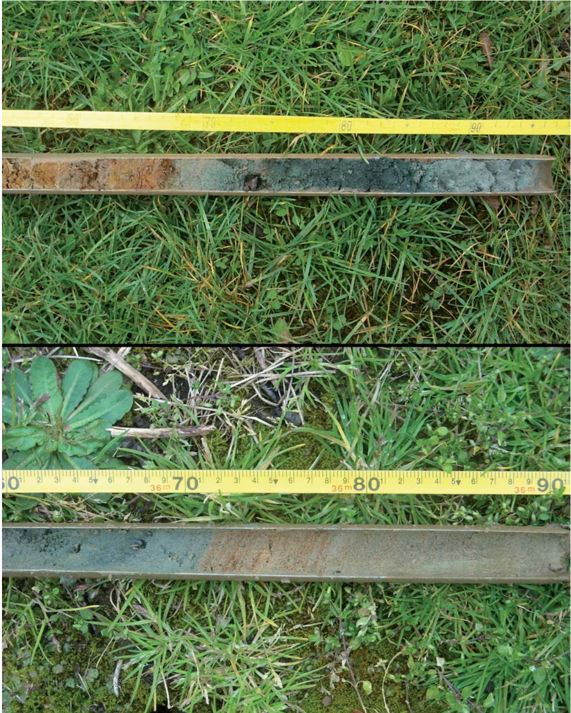
Figuur 47. Diverse bodemprofielen in de gutsboor.
