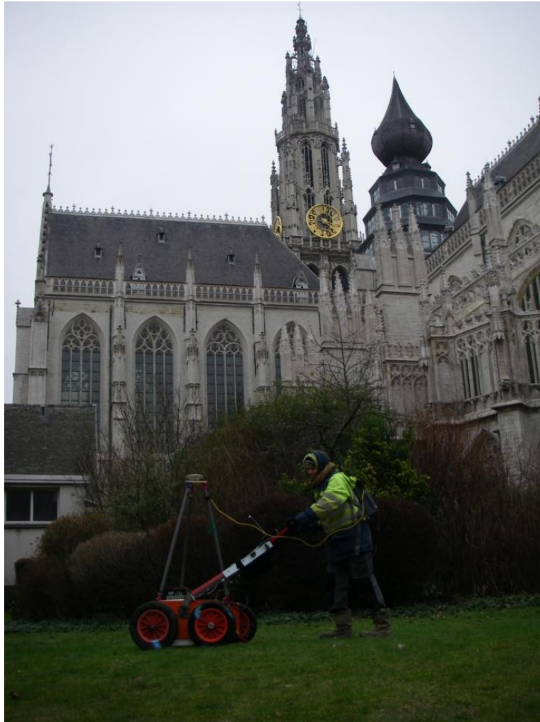
Figuur 4: Een multi-antenne GPR STREAM X 200 MHz, voorgetrokken op het terrein.
