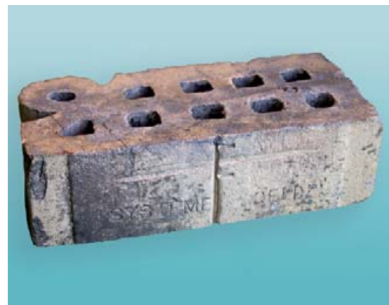
FOTO'S 29: Baksteen gebruikt voor schuilplaatsen Frontzate (foto W. Hulstaert) Baksteen gevonden in de gracht naast de Frontzate. De stoomsteenbakkerij Briqueteries, Tuileries et Céramiques (Système Geldens) à Nieuport was gelegen aan de Ramskapellestraat in Nieuwpoort.
