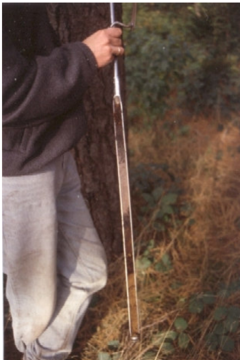
Fig. 7 Zandguts met podzolprofiel.
