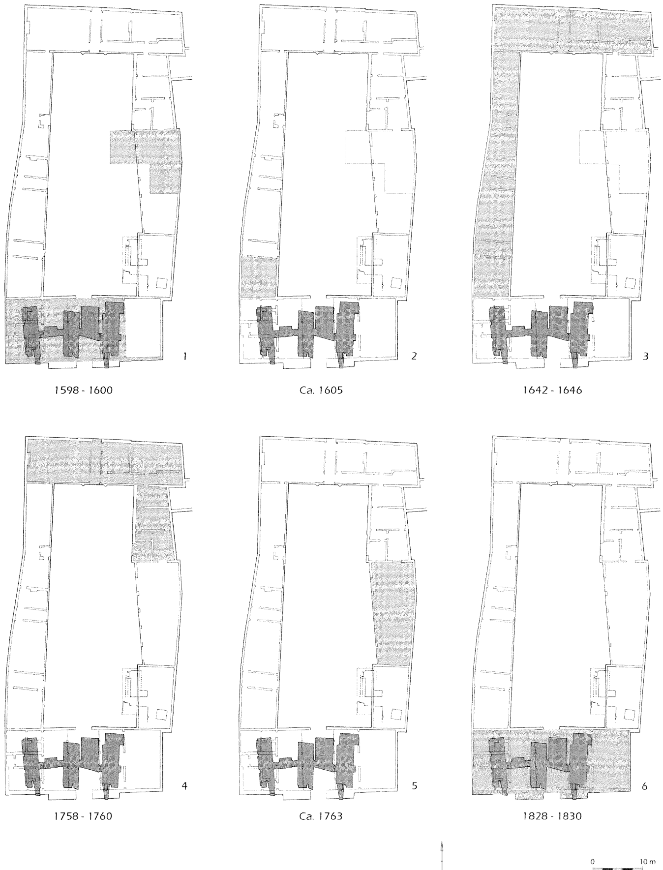
10 Overzicht van de verschillende bouwfases van het landhuis en stadhuis. Scheme of the construction phases of the townhall.
