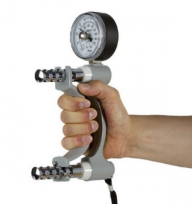
Figura 6. Posición de la mano en la fuerza de agarre mediante dinamómetro Jamar
