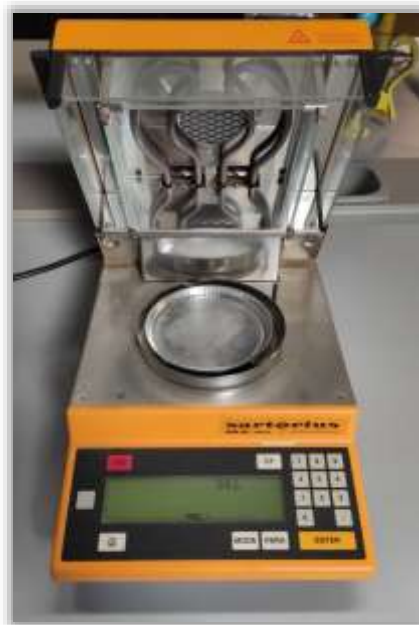
Figura 19. Imagen del analizador automático Sartorius MA40 utilizado para la medición del contenido de humedad.
