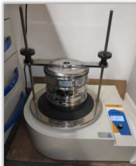
Figura 20. Imagen de la tamizadora vibratoria CISA y de las cribas utilizadas para tamizar el material vegetal molido.
