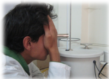
Imagen N° 16. Lectura de temperatura en la bomba. Fuente: Los Autores
