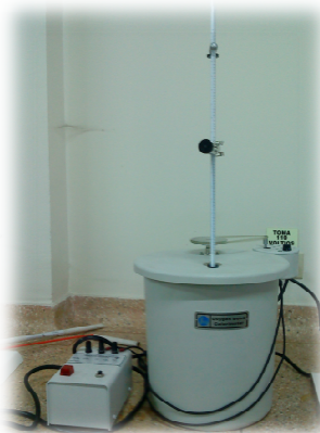
Imagen N° 15. Montaje Bomba Calorimétrica de Oxígeno
