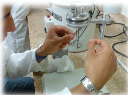
Imagen N° 14. Colocación de alambre en la bomba. Fuente: Los Autores
