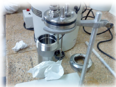
Imagen N° 13. Colocación de crisol en la bomba. Fuente: Los Autores
