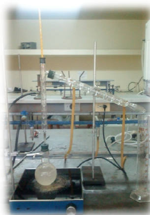
Imagen N° 10. Montaje de destilación. Fuente: Los Autores
