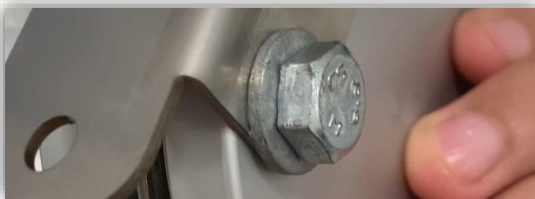
Figura 26. Señal en el tornillo CS M 8.8
