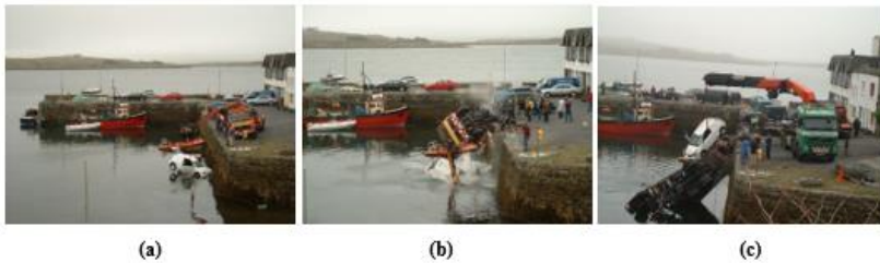
Gambar 5. 2 (a) sebuah crane digunakan untuk mengangkat mobil yang jatuh ke dermaga (b) crane ikut jatuh ke dermaga karena tidak memperhitungkan aspek penyebab gaya (c) crane yang lain digunakan untuk mengangkat mobil dengan memperhitungkan aspek penyebab gaya
