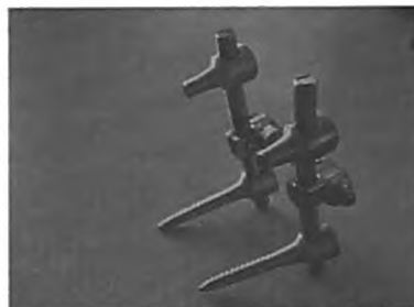
Рис. 5. Общий вид удаленной конструкции с дефектами резьбовых стержней
