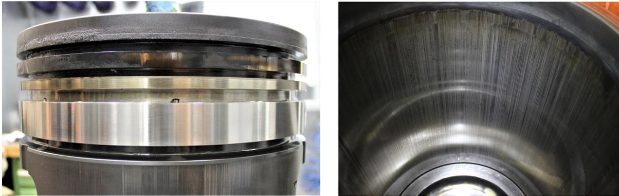
Abbildung 2.12 Motorschaden infolge klopfender Verbrennung: thermisch überlastete Kolbenkronen (linkes Bild) und dadurch zerstörte Honung der Laufbuchse (rechtes Bild)
