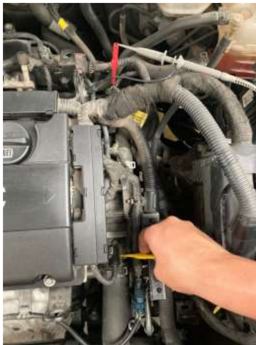
Figura 2.26. Conexionado para medición de sincronía de sensores CKP y CMP del Chevrolet Cruze
