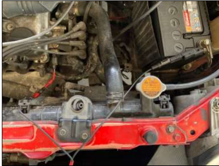
Figura 2.22. Conexiones de la sonda de medición al CMP del Hyundai Atos.
