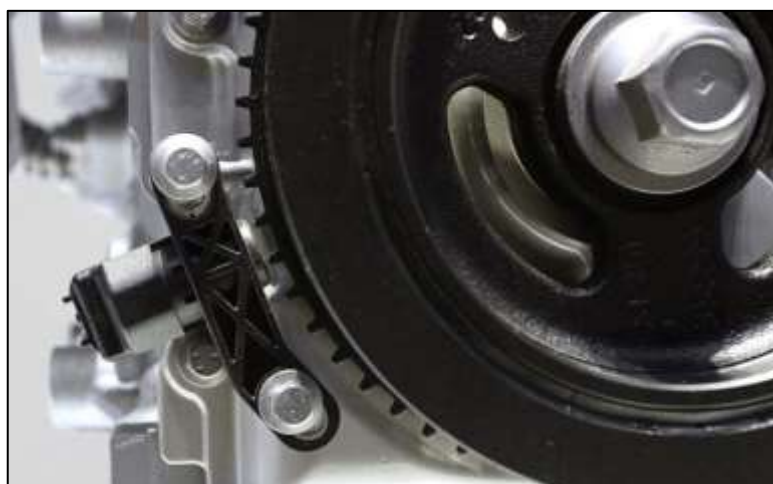
Figura 1.8. Sensor de posición de cigüeñal (AutoAvance, 2019)
