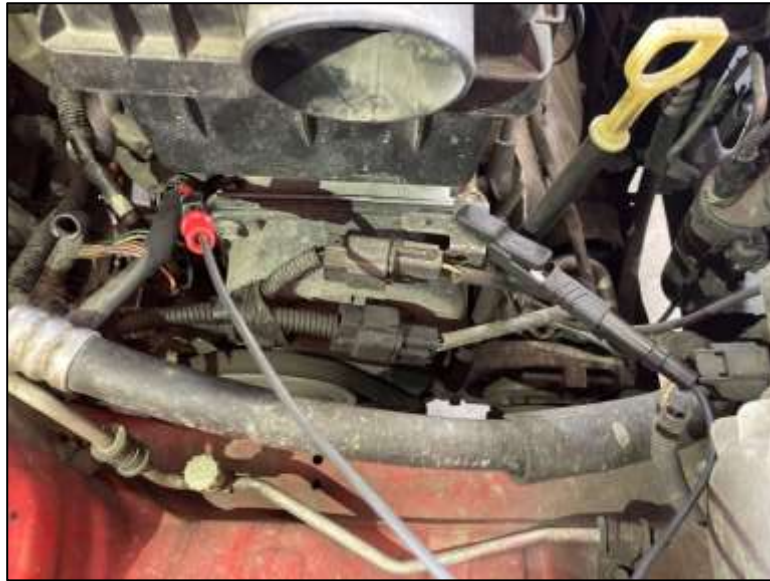
Figura 2.19. Conexión de la sonda de medición al sensor CKP del Hyundai Atos
