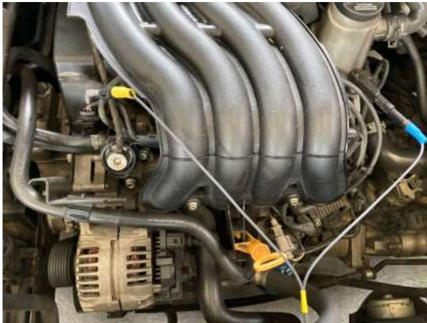
Figura 2.18. Conexión de la sonda de medición al sensor CKP del Volkswagen Jetta.
