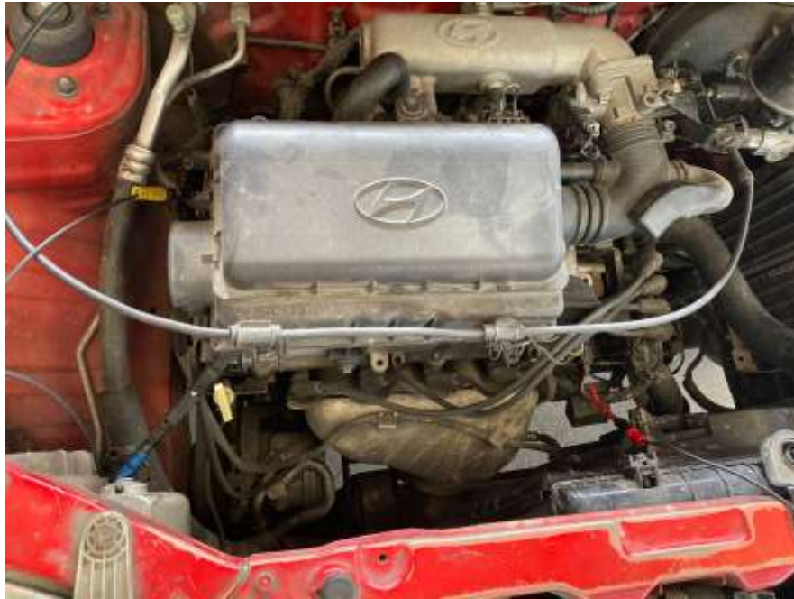
Figura 2.25. Conexionado para medición de sincronía sensores CKP y CMP del Hyundai Atos.
