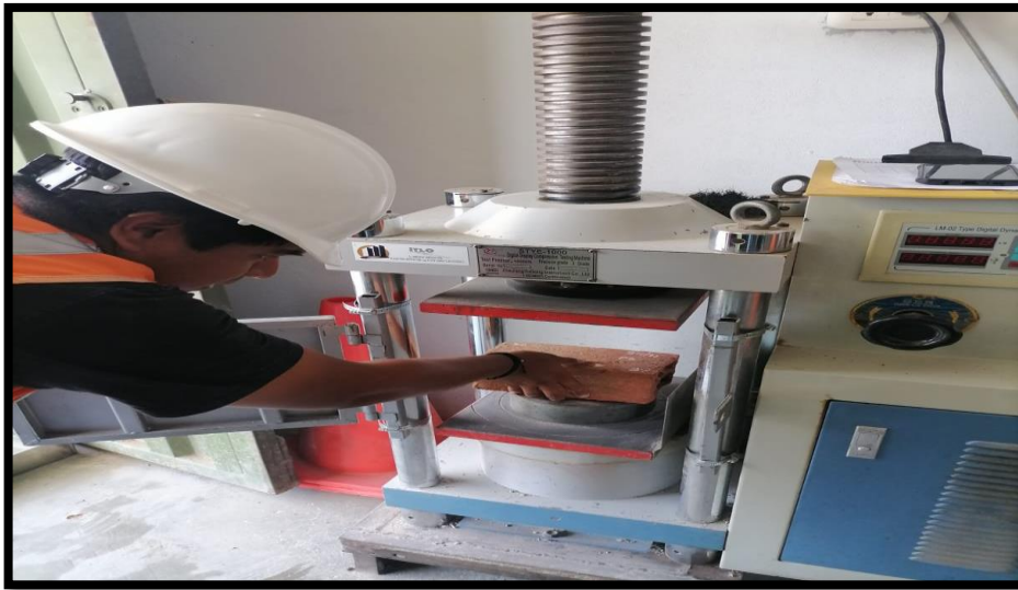
FOTO N°11: se observa al tesista fiesta Amaya realizando el ensayo de resistencia a la compresión de los ladrillos con 2%, 4% y 6% de plástico pet
