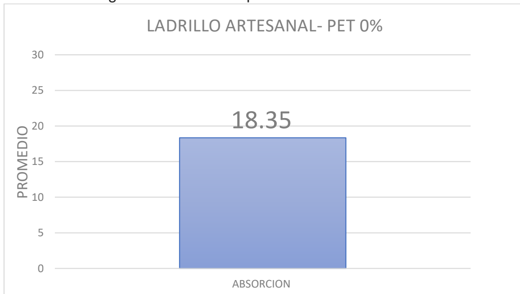
Figura 09: Absorción promedio del ladrillo sin PET
