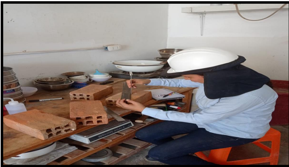
FOTO N°8: se observa a la tesista Adrianzén realizando el ensayo de alabeo para identificar si existen incongruencias como curvaturas ya sean cóncavas o convexas
