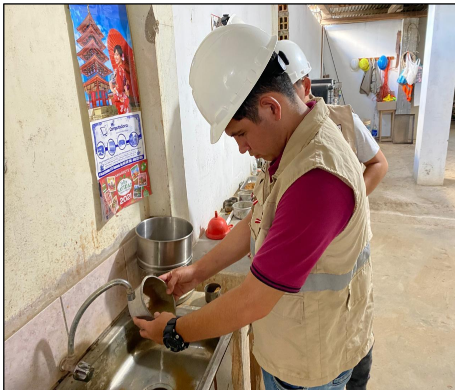
Lavado de análisis granulométrico por tamizado del agregado fino, grueso y global NTP 400.012 - AGREGADOS.
