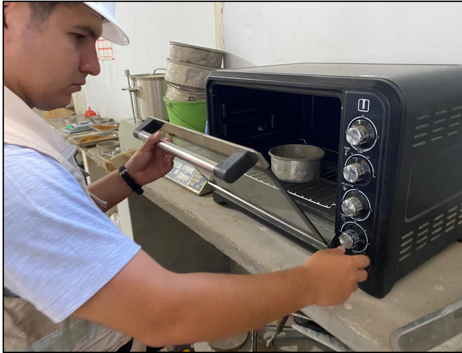
Proceso de secado en horno de granulometría, humedad constante a 110° C, humedad constante - Ensayo de Contenido de Humedad NTP 339.127.
