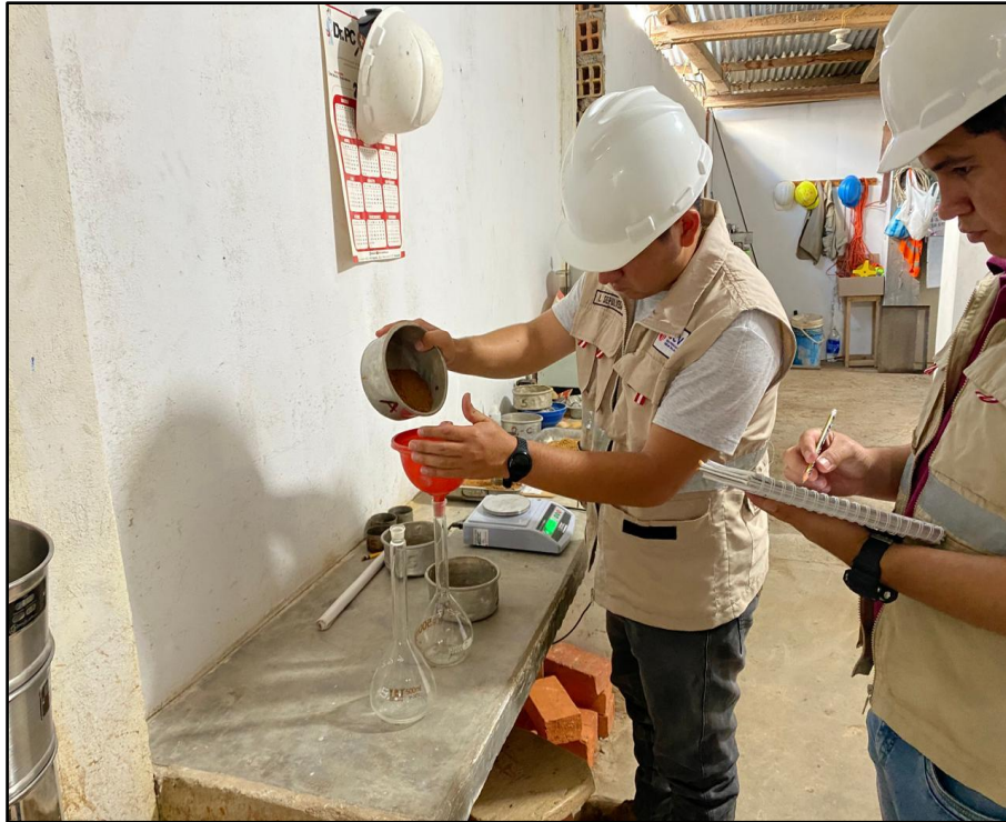
Realización del ensayo método normalizado para la densidad relativa (peso específico) y absorción del agregado fino NTP 400.022 – 2013.
