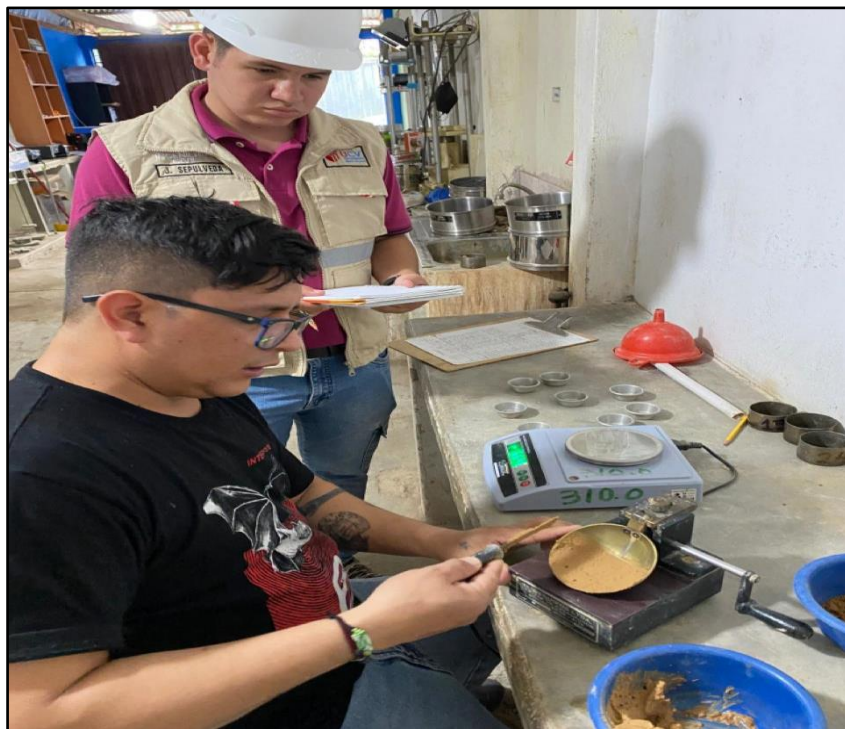
Proceso de secado en horno de granulometría, humedad constante a 110° C, humedad constante - Ensayo de Contenido de Humedad NTP 339.127.
