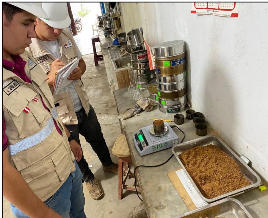
Proceso de toma de muestra para el ensayo de humedad natural, humedad constante a 110° C, - Ensayo de Contenido de Humedad NTP 339.127.
