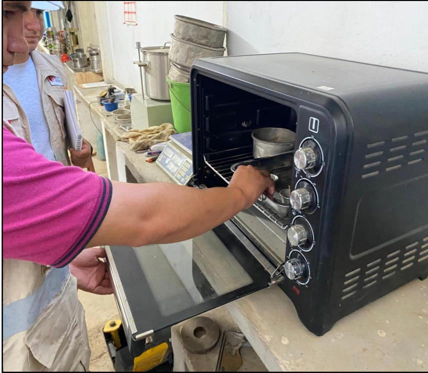
Proceso de secado en horno, humedad constante a 110^{\circ} C, humedad constante - Ensayo de Contenido de Humedad NTP 339.127.
