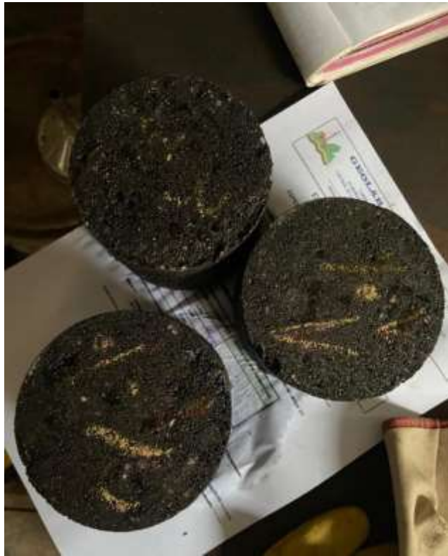
Imagen 9: Briquetas adicionadas con PET al 1.00%
