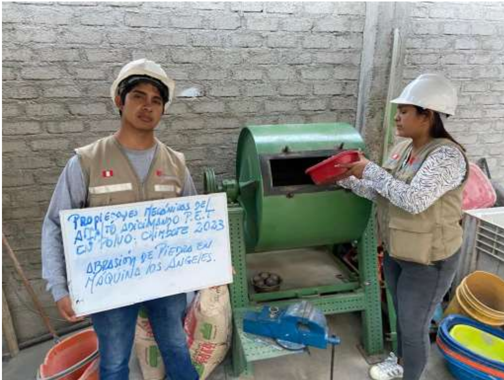
Imagen 5: Estudiantes ingresando el agregado grueso a la máquina de los ángeles
