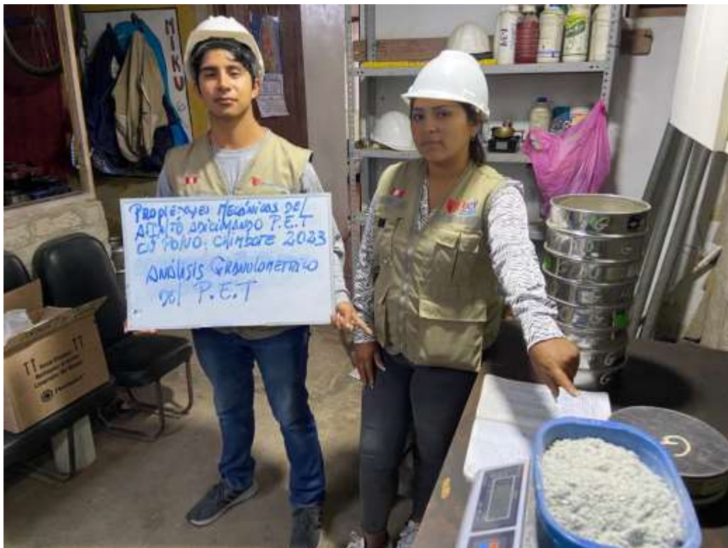
Imagen 6: Estudiantes pesando el PET en polvo para el análisis granulométrico
