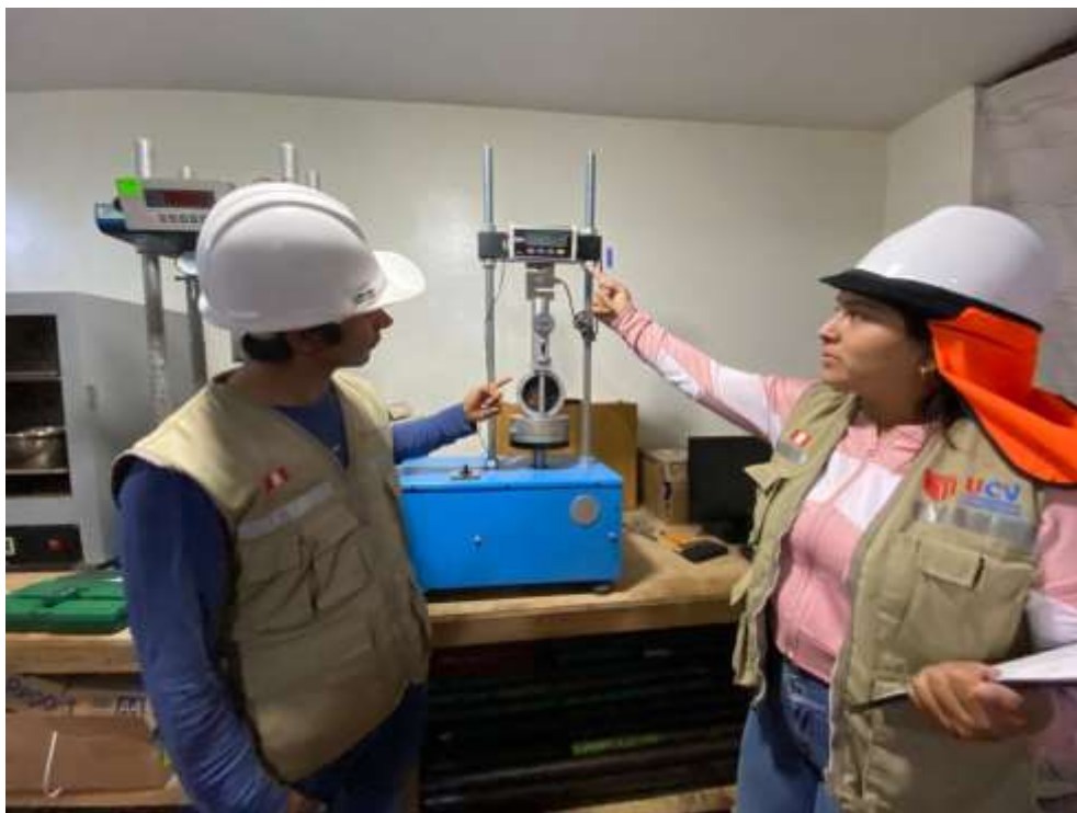
Imagen 12: Estudiantes anotando los datos arrojados por el ensayo Marshall
