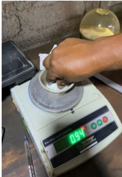
Imagen 11: Pesando el PET en polvo para la adición en la mezcla asfáltica en caliente
