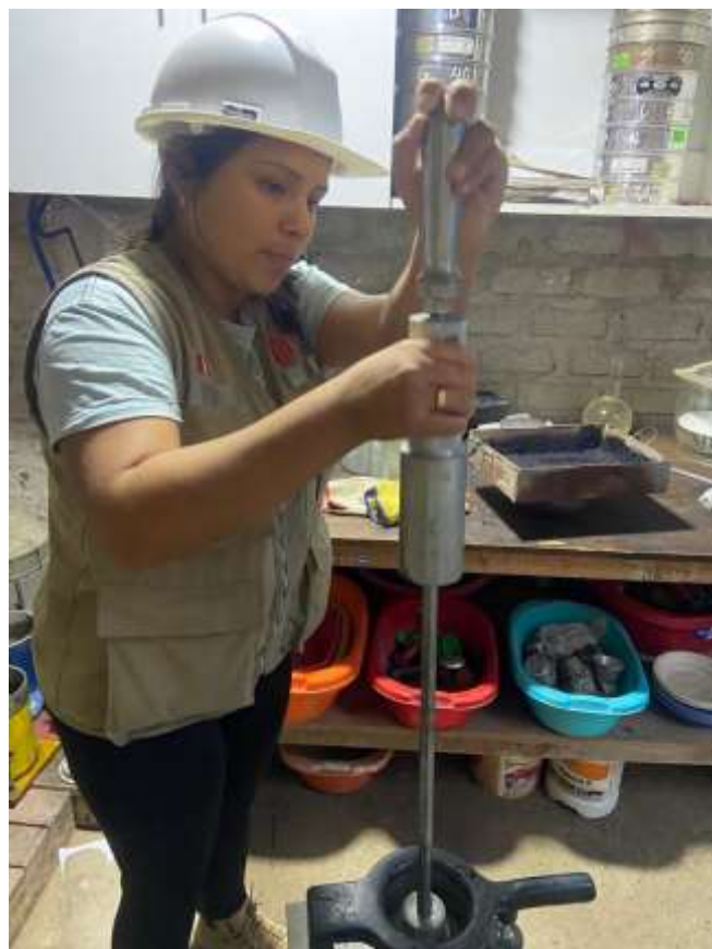
Imagen 10: Estudiantes realizando los golpes necesarios para las briquetas
