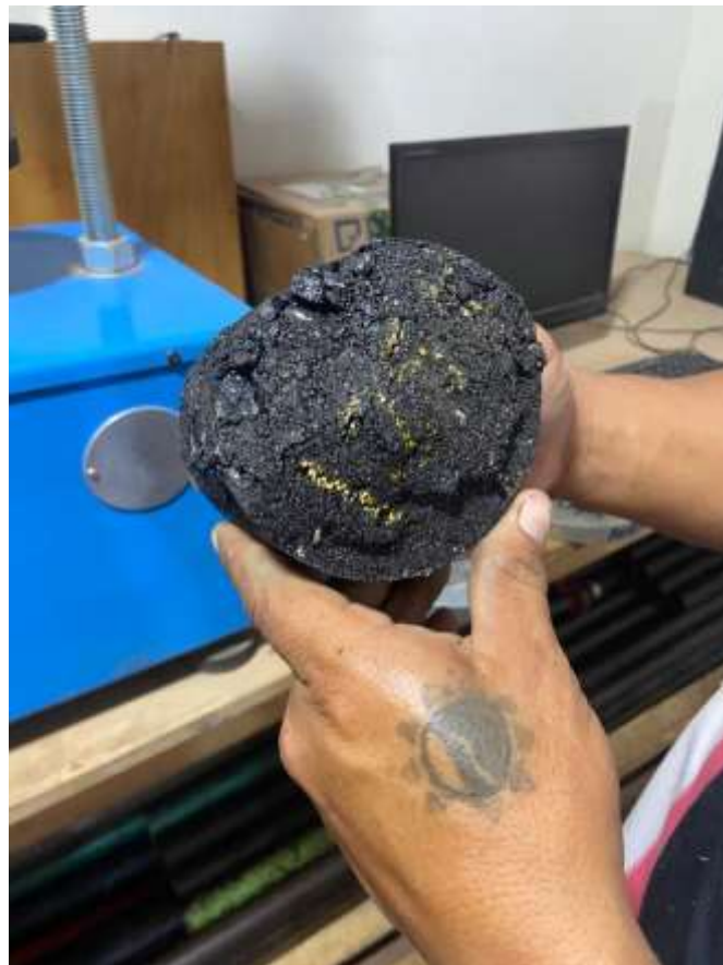
Imagen 14: Briqueta luego de haber obtenidos los datos del ensayo Marshall
