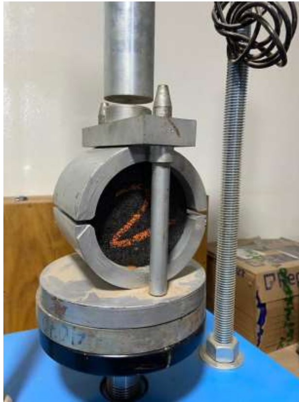
Imagen 14: Briqueta luego de haber obtenidos los datos del ensayo Marshall
