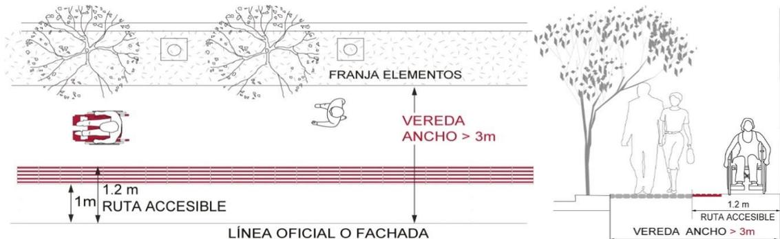
Figura 79. Instalaciones de huella podo táctil en veredas de ancho mayor a 3.00 metros.
