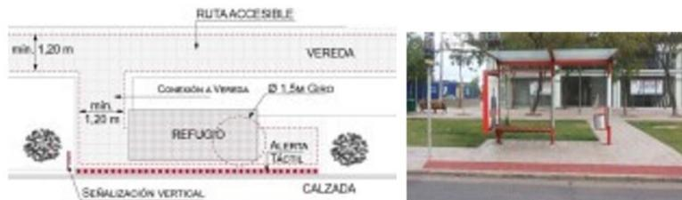
Fig 25: Paradero conectado a nivel con la ruta accesible
