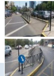
Fig 12: Medianas con circulación peatonal longitudinal a menos de 1 m de la calzada, deben consultar rejas u otro tipo de barrera cuya altura sea de 0,95 m.
