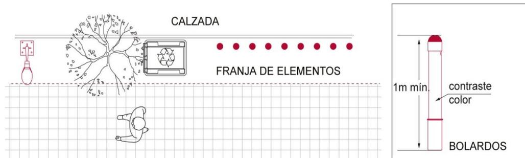
Figura 86. Elementos verticales deben ir alineados con la solera y cercanos a la calzada.
