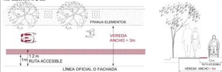
Fig 17 (izq) y Fig 18 (der): instalación de huella podotáctil en veredas de ancho mayor a 3 metros
