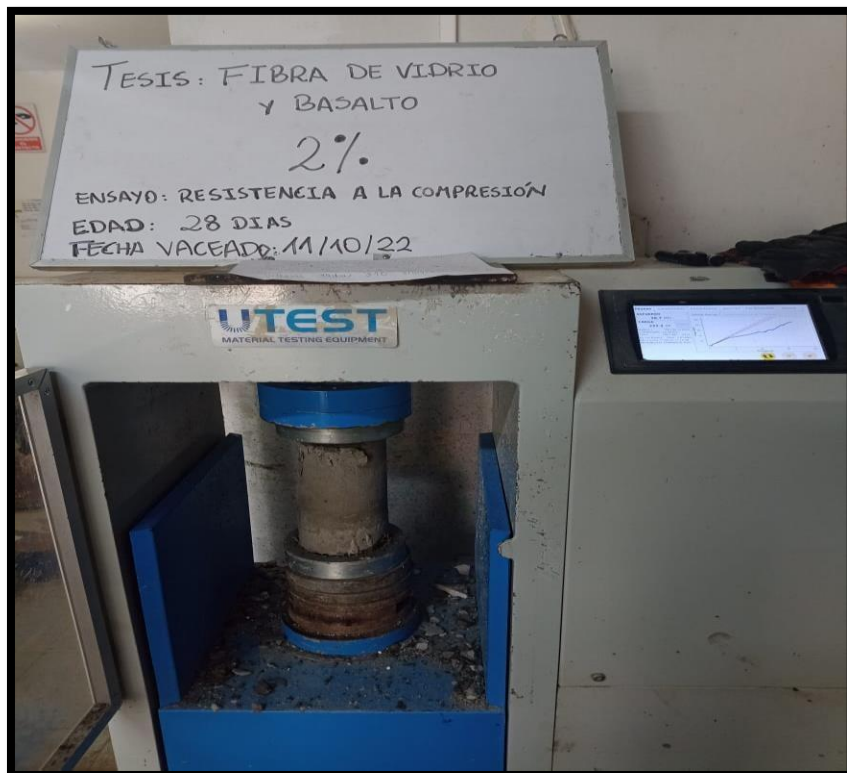
Foto 14: Ensayo a compresión de la probeta añadiendo 2% de fibras de vidrio y basalto a los 28 días
