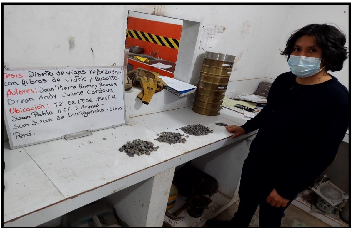
Foto 12: Análisis granulométrico del agregado grueso por el método de tamizado
