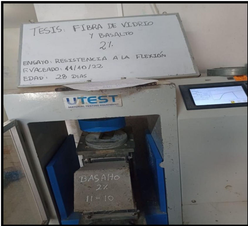
Foto 17: Ensayo a flexión de la viga añadiendo 2% de fibras de vidrio y basalto a los 28 días
