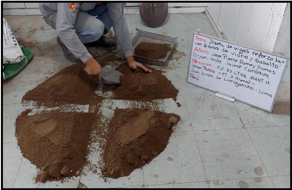
Foto 3: Cuarteo del agregado fino
