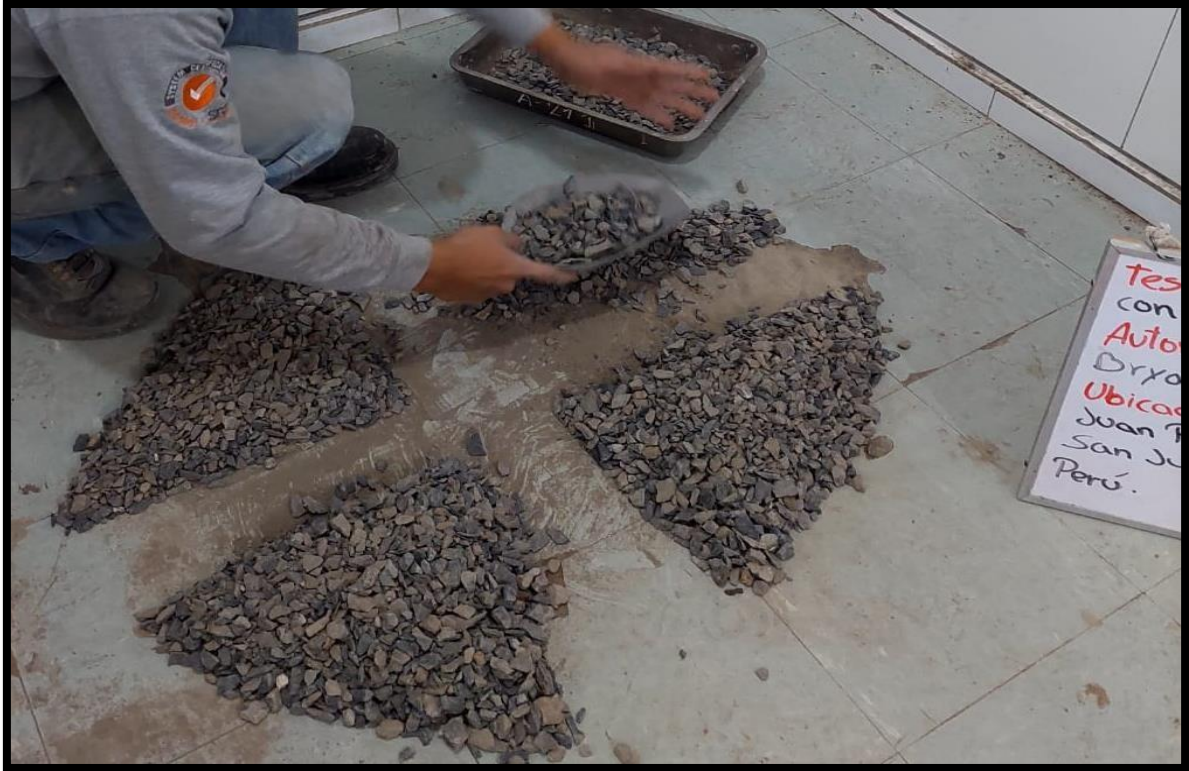
Foto 9: Cuarteo del agregado grueso
