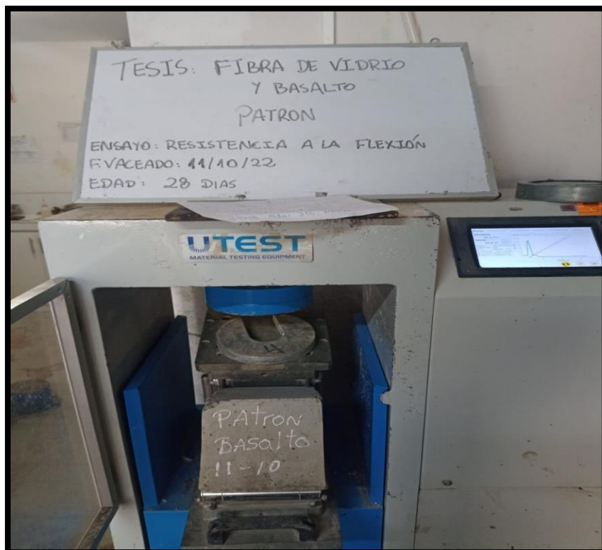
Foto 16: Ensayo a flexión de la viga patrón a los 28 días
