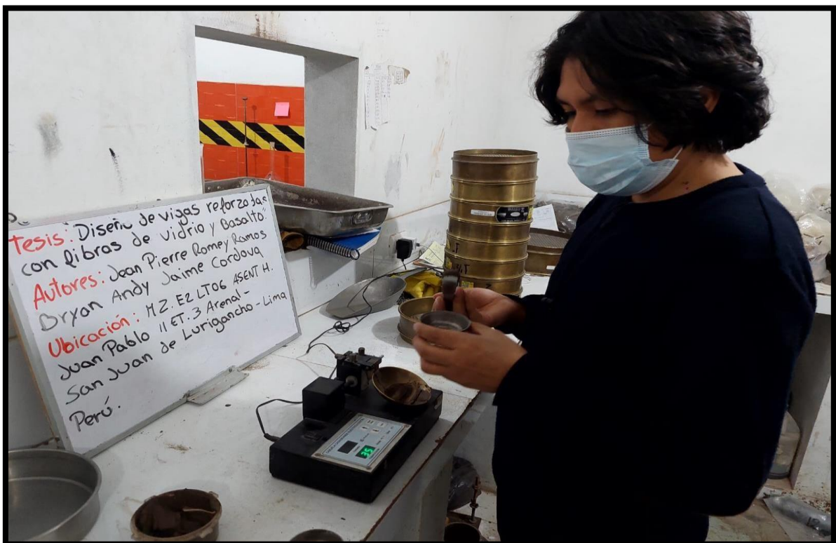
Foto 8: Determinación del límite plástico mediante la copa de casa grande
