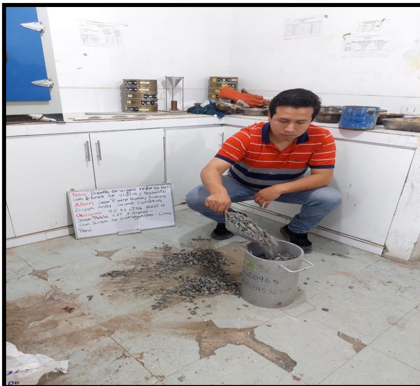
Foto 10: Toma de muestra representativa en la tara
