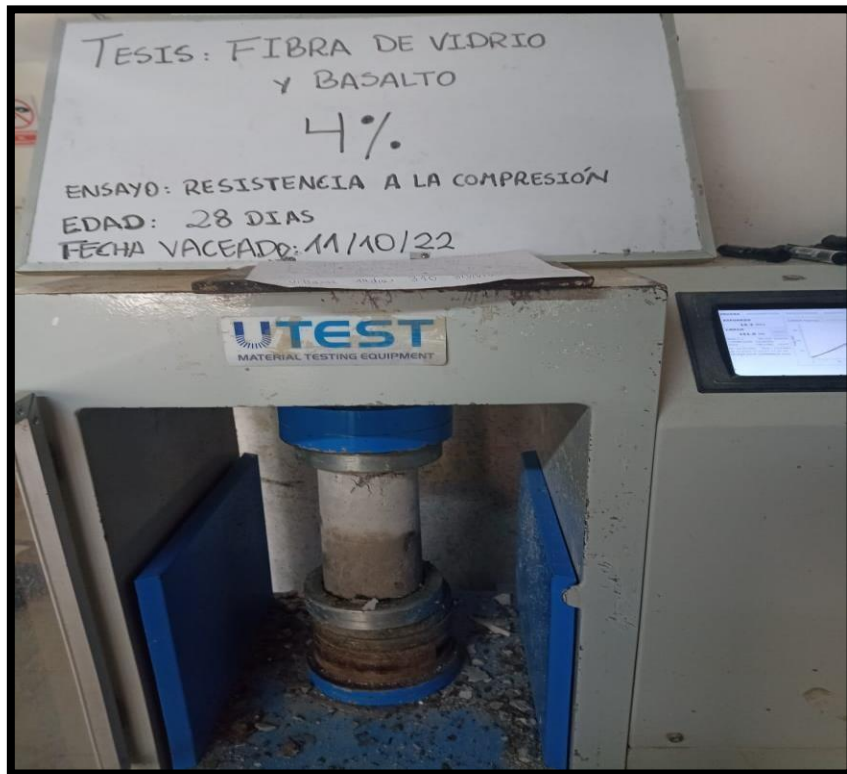
Foto 15: Ensayo a compresión de la probeta añadiendo 4% de fibras de vidrio y basalto a los 28 días
