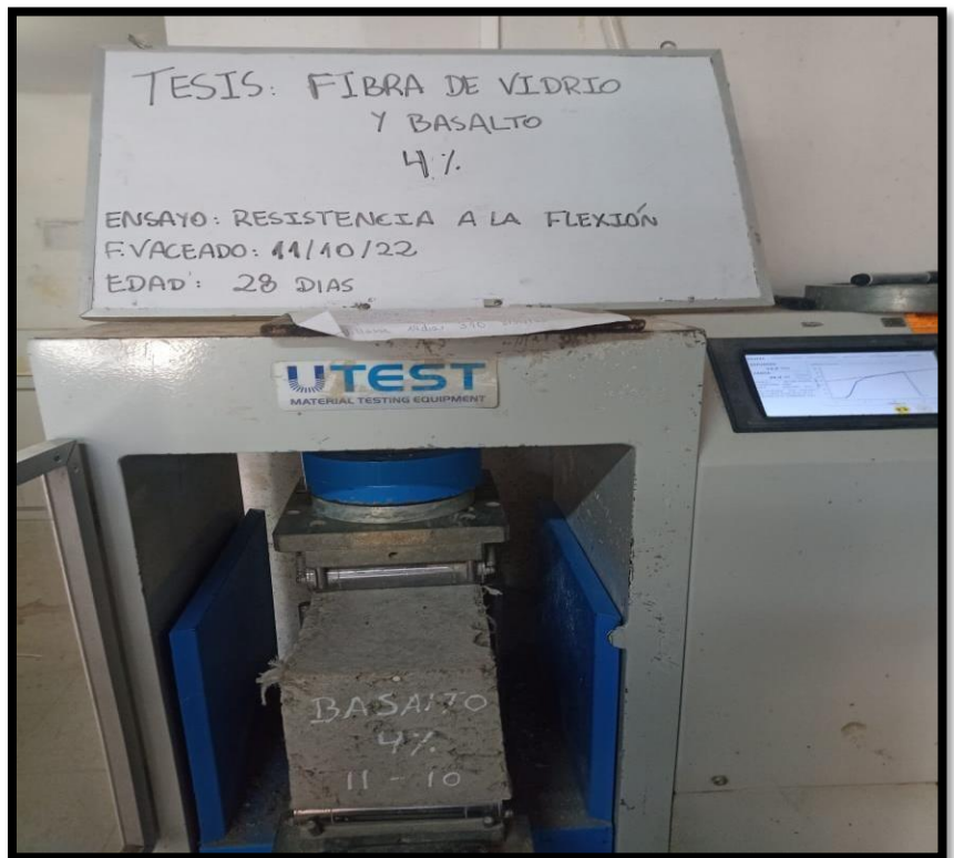
Foto 18: Ensayo a flexión de la viga añadiendo 4% de fibras de vidrio y basalto a los 28 días
