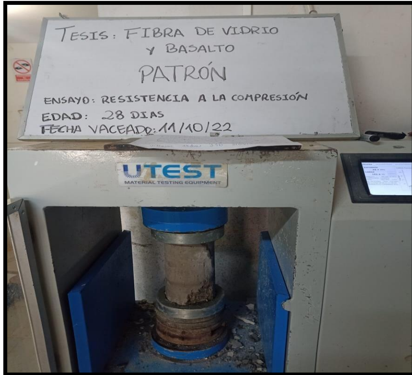
Foto 13: Ensayo a compresión de la probeta patrón a los 28 días
