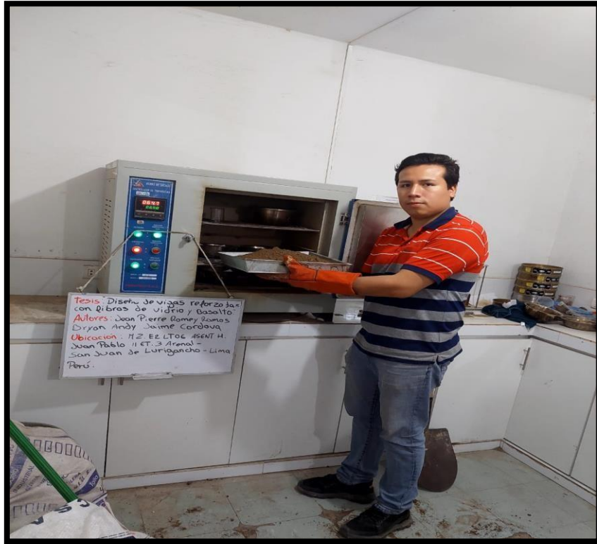
Foto 5: Muestra dejada en el horno para luego determinar el contenido de humedad
