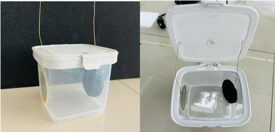
Figura 23. Construcción de las CCM.
