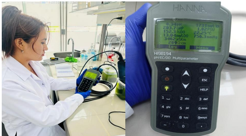
Figura 44. Monitoreo de pH, oxígeno disuelto, conductividad eléctrica y sólidos totales disueltos del agua residual en la segunda etapa operativa.
