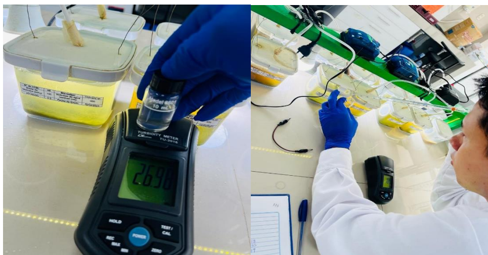
Figura 36. Monitoreo de la turbidez del agua residual en la primera etapa.
