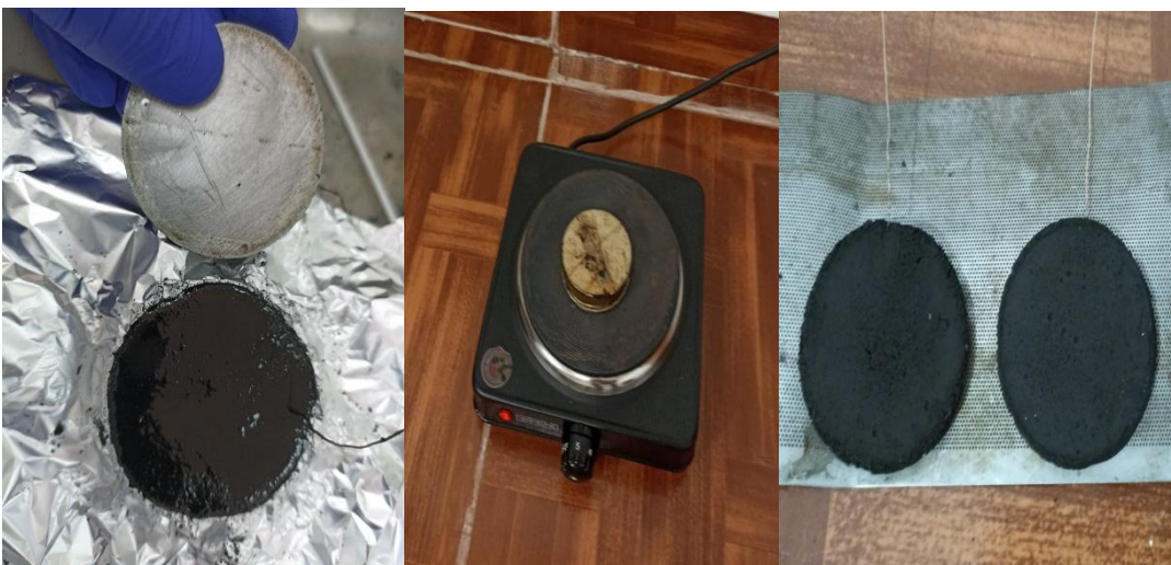
Figura 24. Fabricación de los electrodos de carbón activado.
