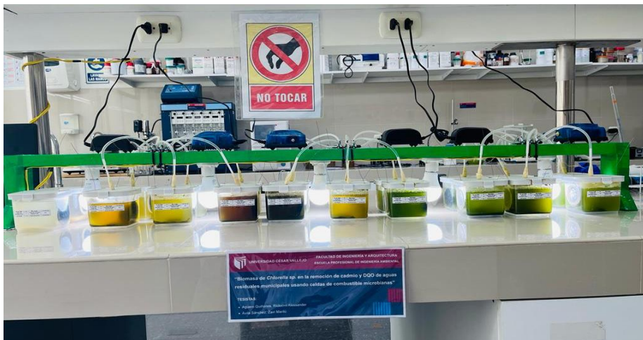
Figura 33. Acondicionamiento de las CCM con bombas de aireación e iluminación artificial durante la primera etapa.
