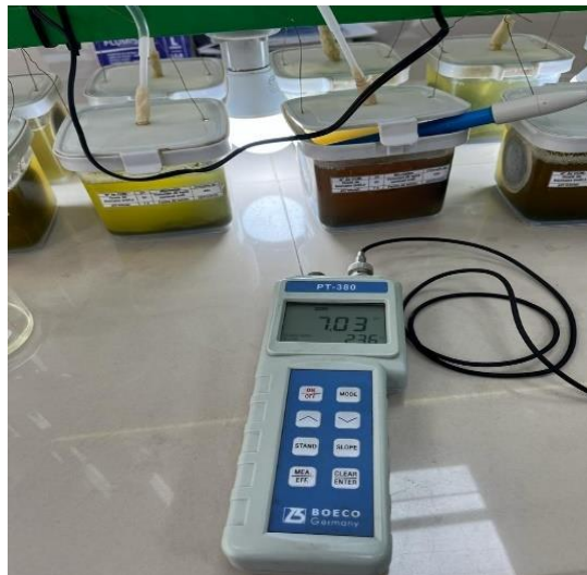
Figura 35. Monitoreo del pH del agua residual en la primera etapa operativa.
