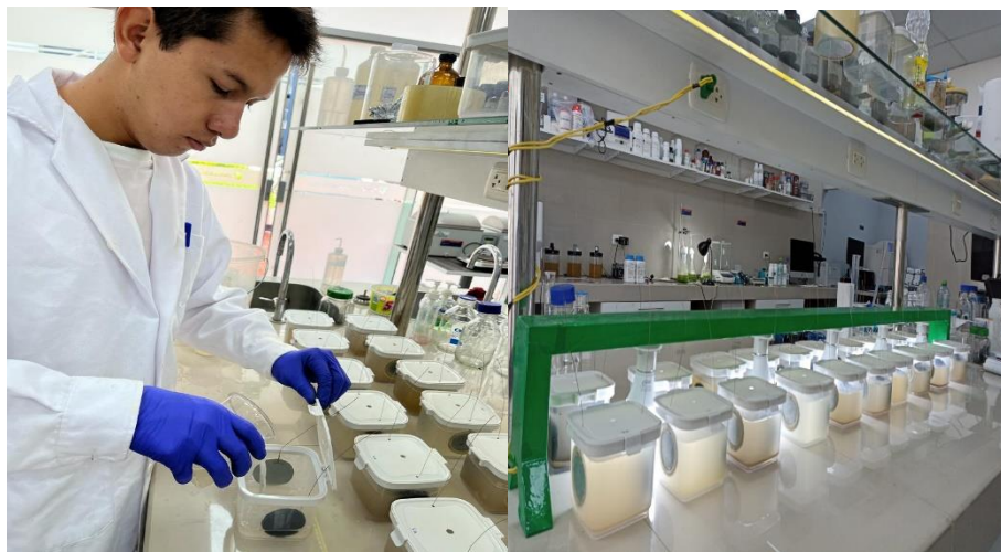
Figura 31. Incorporación del agua residual municipal a las CCM.
