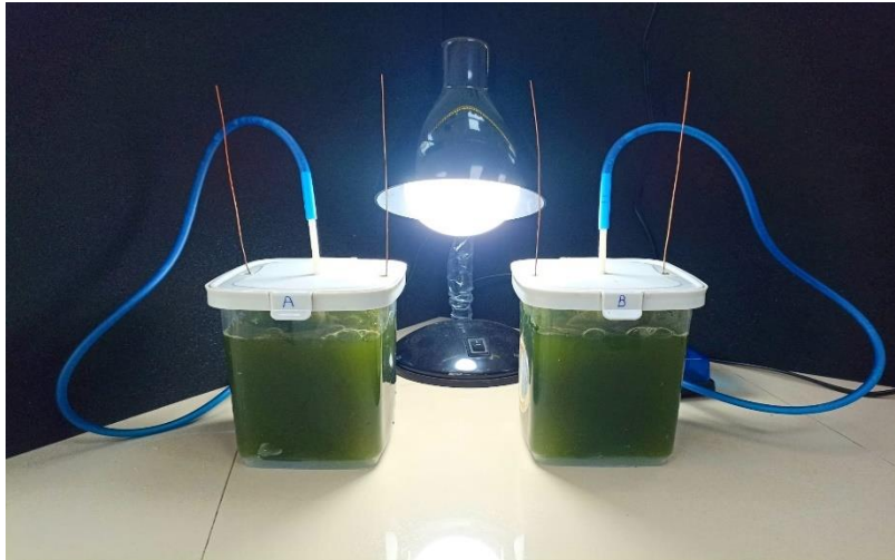
Figura 43. Acondicionamiento de bombas de aireación e iluminación artificial a las CCM en la segunda etapa operativa.
