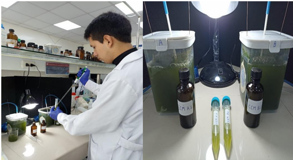
Figura 47. Toma de muestra del agua residual de las CCM cada 3 días para los análisis de cadmio y DQO.
