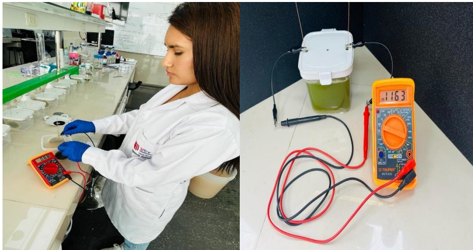
Figura 34. Monitoreo de voltaje y corriente de las CCM en la primera etapa operativa.
