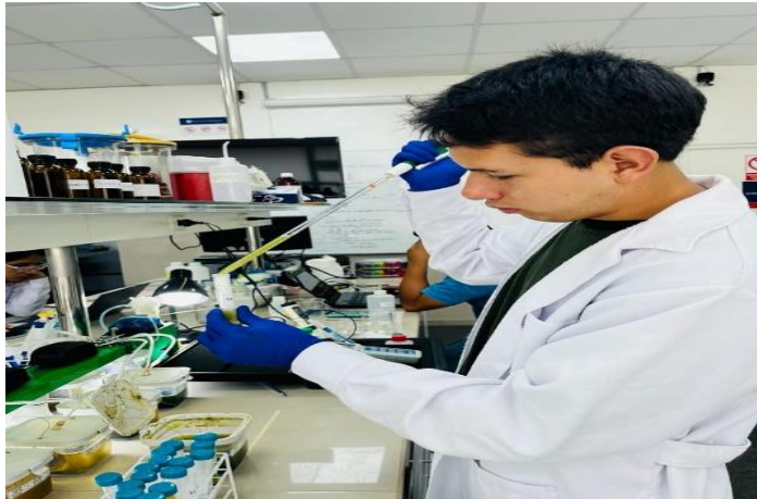
Figura 37. Toma de muestra de biomasa para conteo celular y medición de absorbancia.
