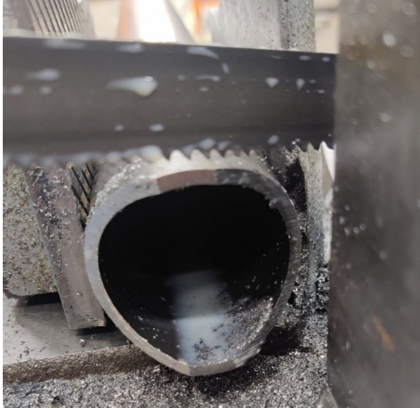
Kuva 6: Segmenttien sahaus jalkaputken alapäästä.
