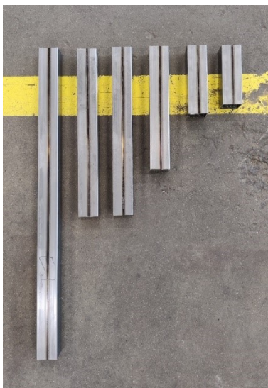
Kuva 9: Tasorakenteen osat sahattuina.
